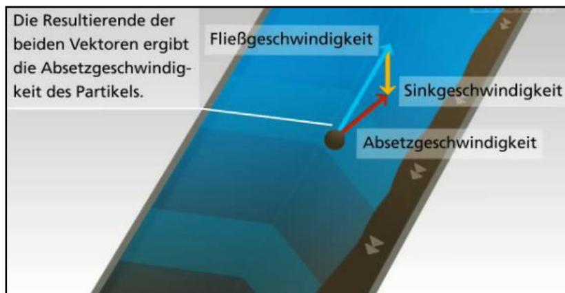
**Abbildung 7.22:** Absetzverhalten der sedimentierfähigen Stoffe in einem Lamellenabscheider (Leiblein, 2013)
