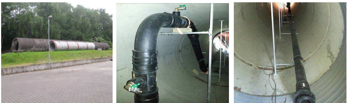
Bild 5 IKT-eigene Versuchsstrecke aus PE 100
