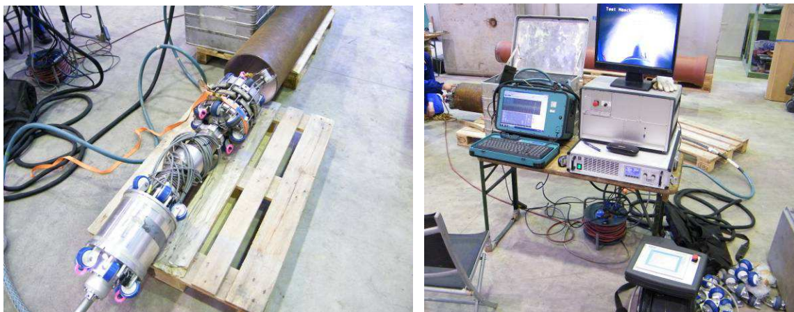
Bild 2 SloFec-Prüfsystem ohne Antrieb (links), Messtechnik zur Auswertung einer Prüfung (rechts)
