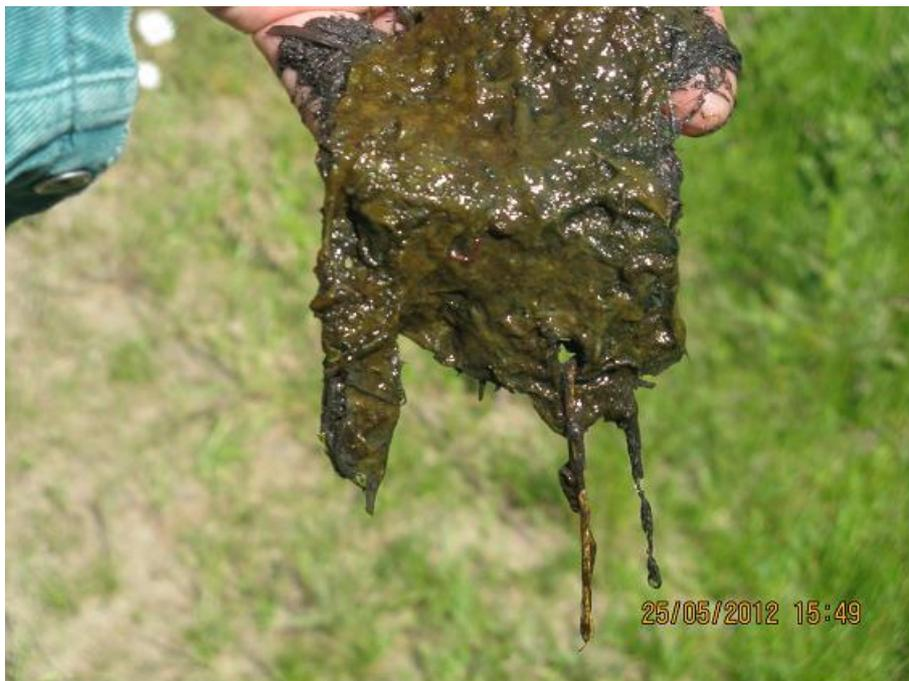
Bild 8-14: Die Algenfladen auf der Filteroberfläche sind durch Filterüberstau im Frühjahr (Förderung der Schilfentwicklung) entstanden, RBF Bentelerstraße. Die ganzflächige Fladenentwicklung setzt eine geringe Feinpartikelbelastung während der Entwicklungszeit voraus.
