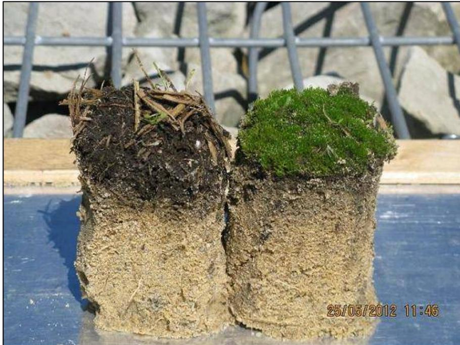
Bild 5-16:RBF Hans-Humpert-Str., Moosbewuchs auf der Filteroberfläche als Indikator geringer Sedimentfracht
