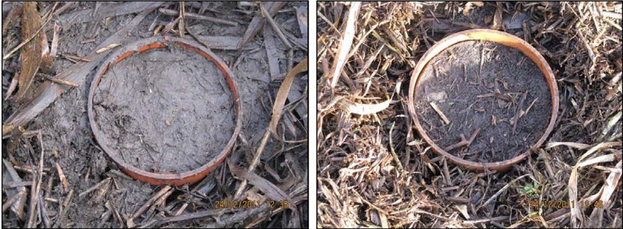
Bild 5-12:RBF-Kenten, Vliesscheibenoberfläche unmittelbar nach einem größeren Beschickungsereignis am 24.12.2011 (links: zulaufnah, rechts: zulauffern)
