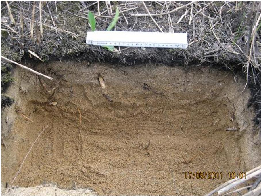
Bild 8-9: Aufgrund der vergleichsweise hohen ablaufseitigen Feinpartikelbelastung von  $0,92 \text{ kgTM/m}^2 \cdot \text{a}$  ( $\Sigma 10,2 \text{ kgTM/m}^2$  in 11 Jahren) kann auch ablaufseitig das Sediment optisch sicher erkannt werden. RBF Benninghoferweg.
