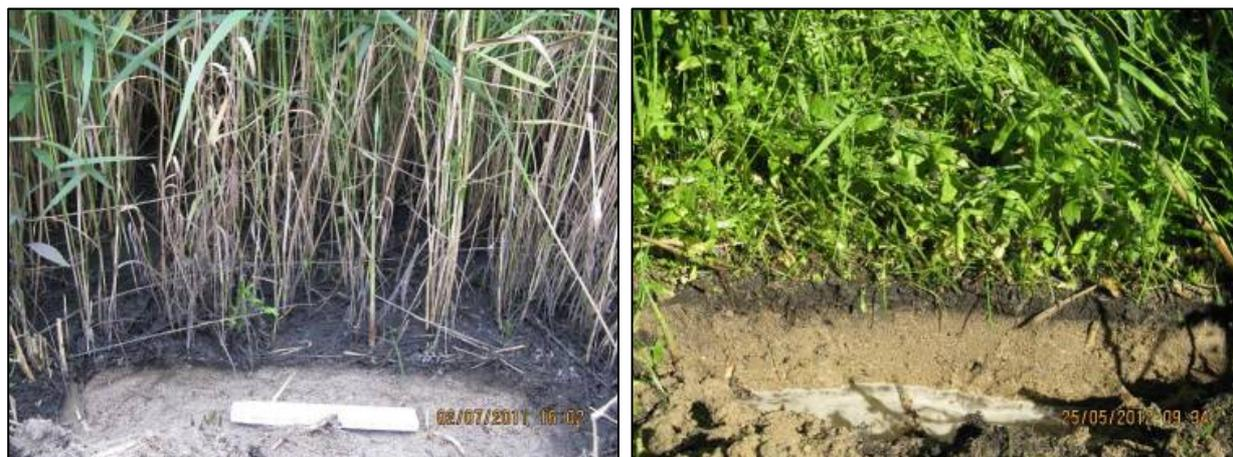
Bild 5-23: Durch die Schilfernte besitzt nicht nur der 2-jährige RBF Bentelerstraße (links), sondern auch der 5-jährige RBF Humpert-Straße (rechts) eine scharfe Grenze zwischen Sediment und Filtersubstrat. Diese scharfe Grenze zeigt die geringe Strukturierung und geringe hydraulische Leitfähigkeit des Sedimentes an
