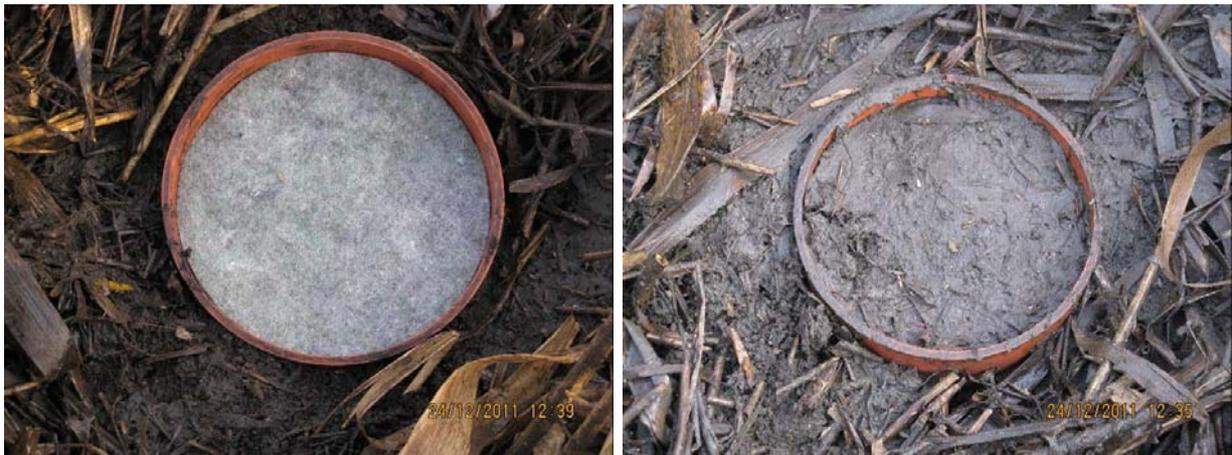
Bild 3-1: Vliesscheiben zur Ermittlung der Feststoffbelastung der Filterflächen. RBF Kenten, zulaufnah, 24.12.2012. Links neue, rechts alte Vliesscheibe
