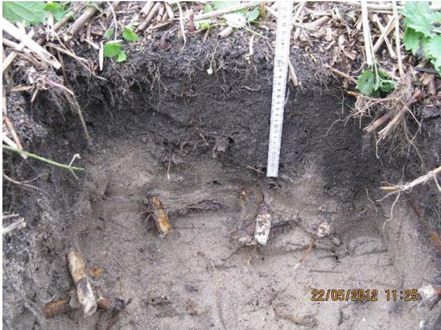
Bild 8-7: Durch die starke Durchmischung von Sediment und Filtersubstrat wird die ursprüngliche scharfe und gerade Grenzlinie sehr diffus und wellig. Zulaufnaher Filterteil des RBF Geilenkirchen.
