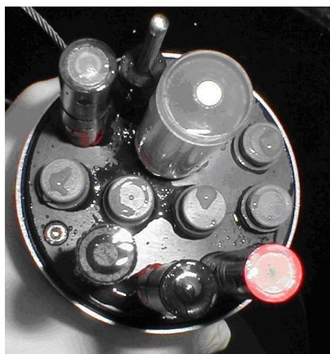
Abbildung 28: Messkopf eines ISE Systems
