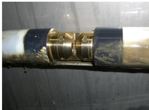
Abbildung 32: Mess-Spalt des Spektrometers nach dem Einsatz im Kanal
