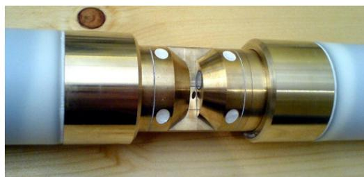
Abbildung 30: Messspalt einer CSB Sonde
