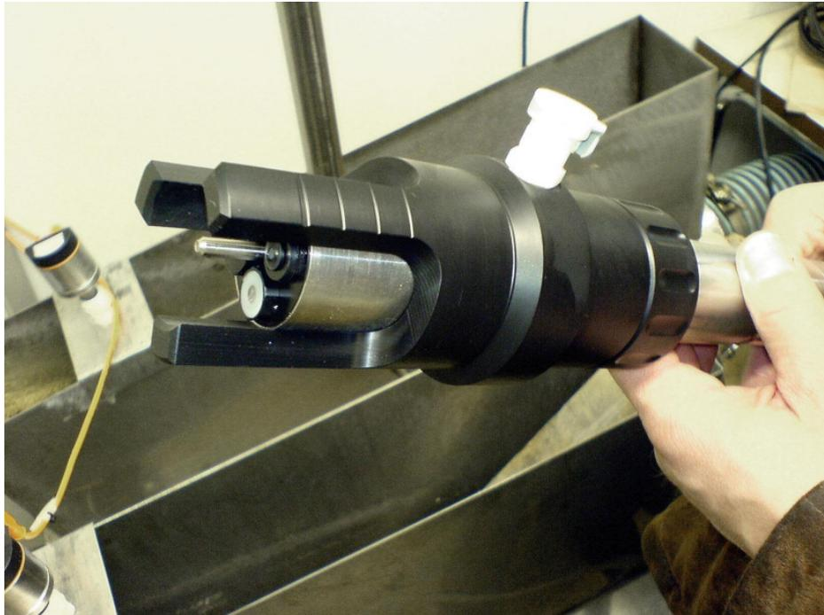
Abbildung 31: Sensorkopf mit aufgesetzter Luftspülung
