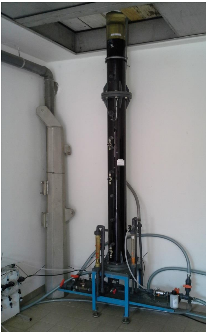
Abbildung 9: In der Vorhalle (links) aufgestellte Filtersäule (Kleinsorbent KA) mit einer Deckendurchführung in die obere Gebläsehalle (rechts)
