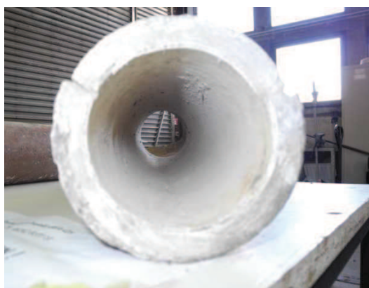
Abbildung 4-62: Probestück IV, schadensfreier Kurzliner
