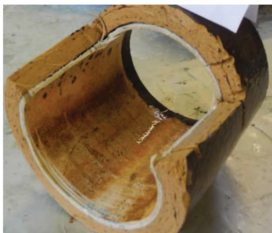
Abbildung 4-68: Probestück VII, Verfärbung im Altrohr
