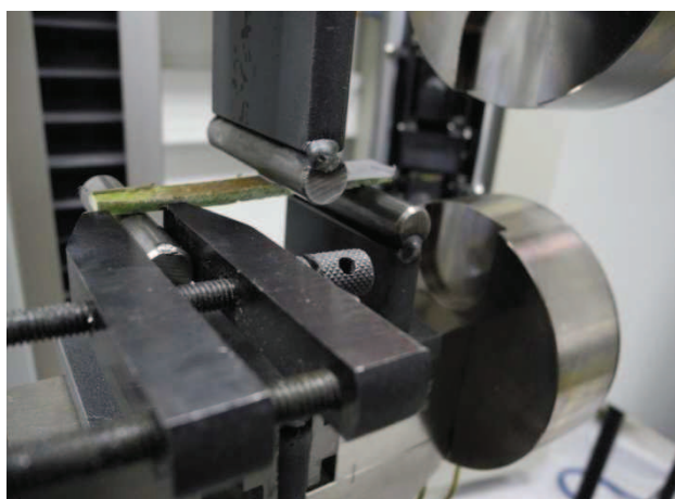
Abbildung 4-74: Probekstück zwischen Auflager und Druckfinne, Prüfmaschine Zwick ProLine Z005
