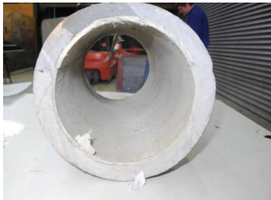
Abbildung 4-61: Probestück III, schadensfreier Kurzliner
