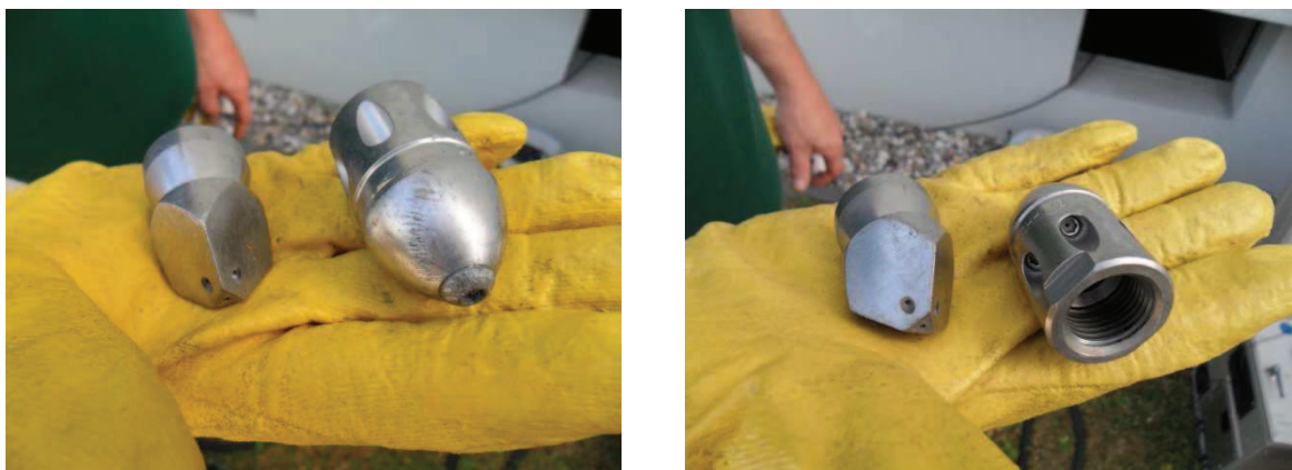
Abbildung 4-29: Eingesetzte Spüldüsen zur Reinigung der zu inspizierenden Grundstücksentwässerungsleitungen
