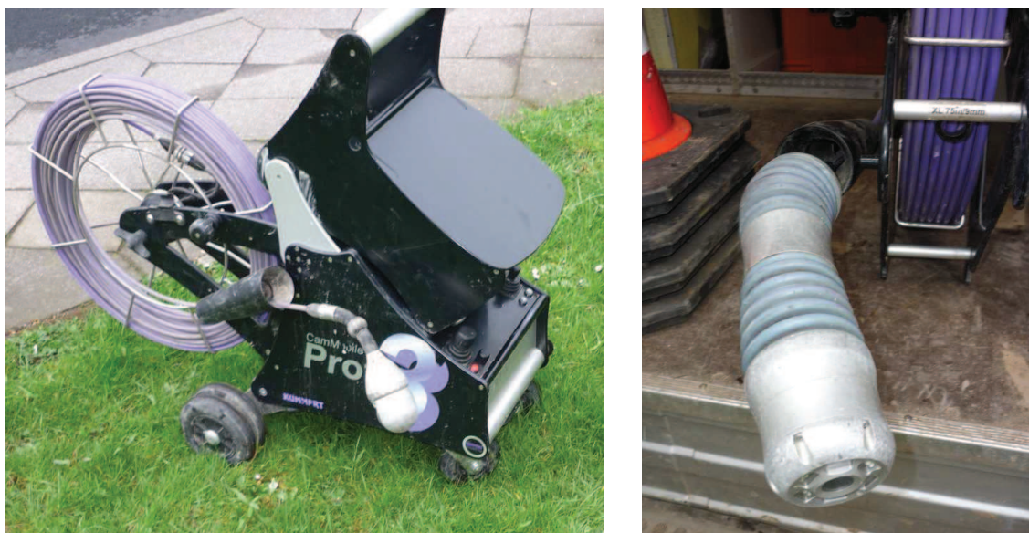
Abbildung 4-30: Kamerasystem der Fa. Kummert (links) und Kamerakopf CamFlex (rechts) zur optischen Inspektion von Grundstücksentwässerungsleitungen
