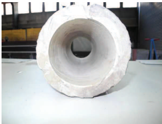
Abbildung 4-64: Probestück VI, schadensfreier Kurzliner
