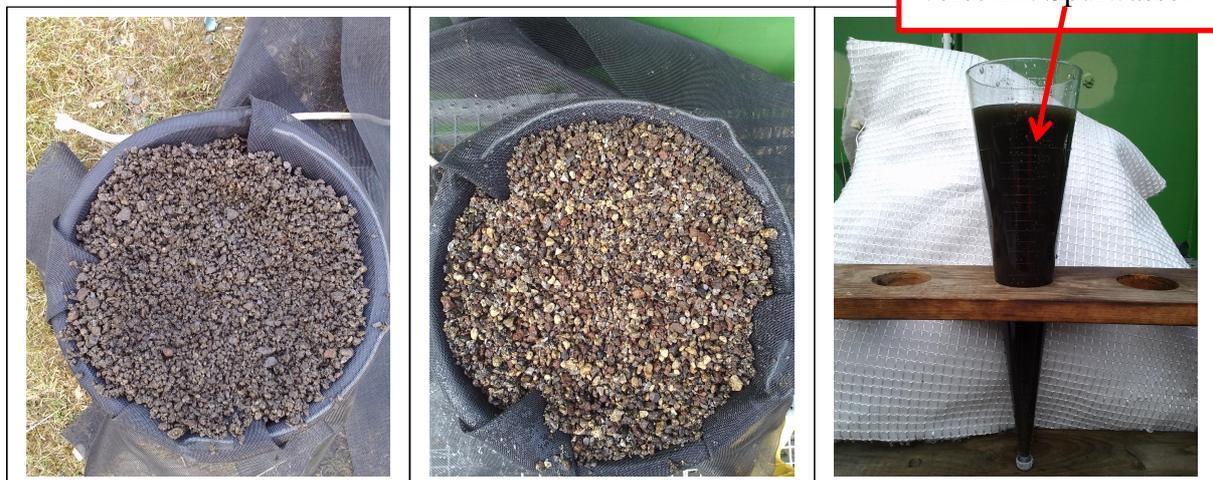
Abbildung 16 Mineralfilter ungespült, gespült, verschmutztes Spülwasser
