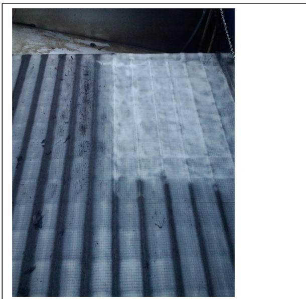
*Abbildung 10 Verstopftes Vlies nach teilweiser Reinigung (Hochdruckreiniger)*
