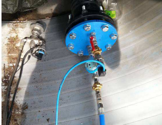
Bild 52 Blindflansch mit montiertem Drucksensor und Zu-/Ablauf (links), Steuer- und Auswerteeinheit (rechts)
