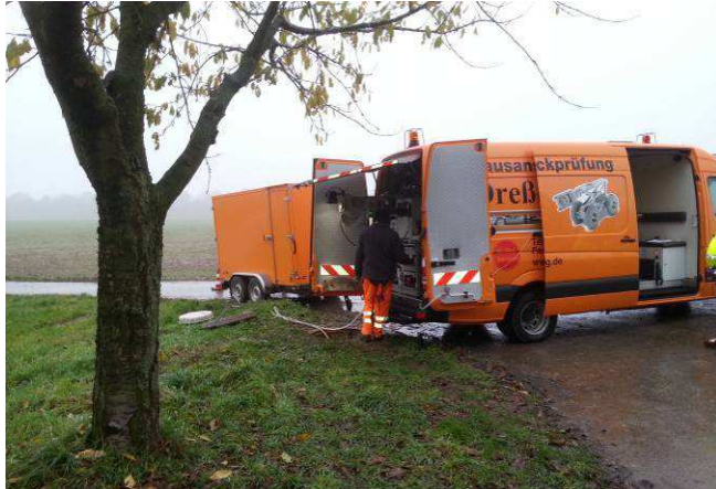
Bild 28 Messfahrzeug der Fa. Dreßen bei der Dichtheitsprüfung (links), Live Auswertung der Messung (rechts)
