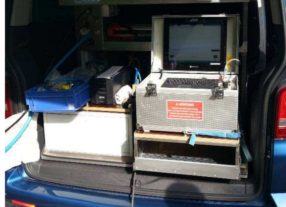
Bild 52 Blindflansch mit montiertem Drucksensor und Zu-/Ablauf (links), Steuer- und Auswerteeinheit (rechts)
