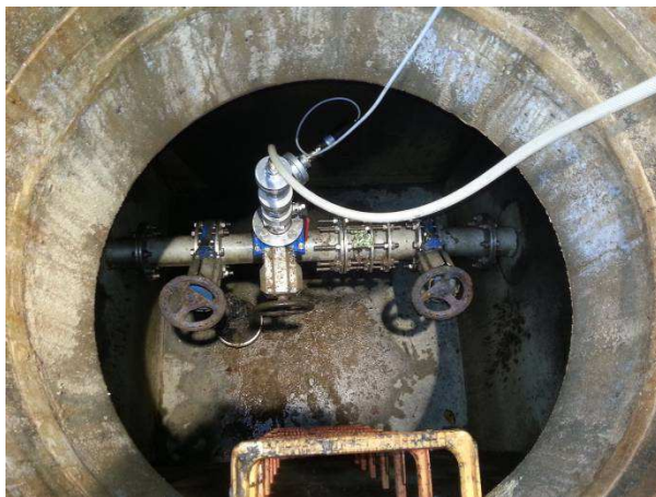
Bild 27 Angeschlossene Messeinrichtung auf dem T-Stück des Prüfschachtes (links), Messfahrzeug zur Druckbeaufschlagung und Ergebnisauswertung (rechts)
