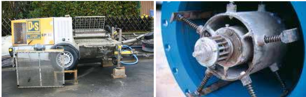
Bild 113 Mörtelpumpe zum Betreiben des Schleudermotors und Kleinrohr-Schleudermotor[116]
