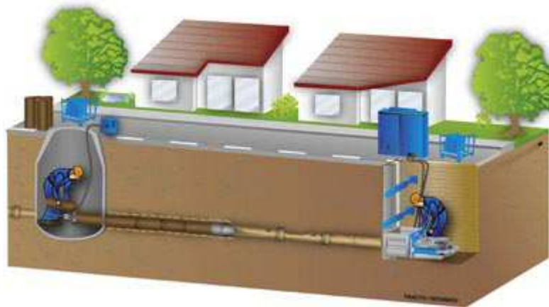
Bild 117 Das Burstlining-Verfahren mit Kurzrohren [120]
