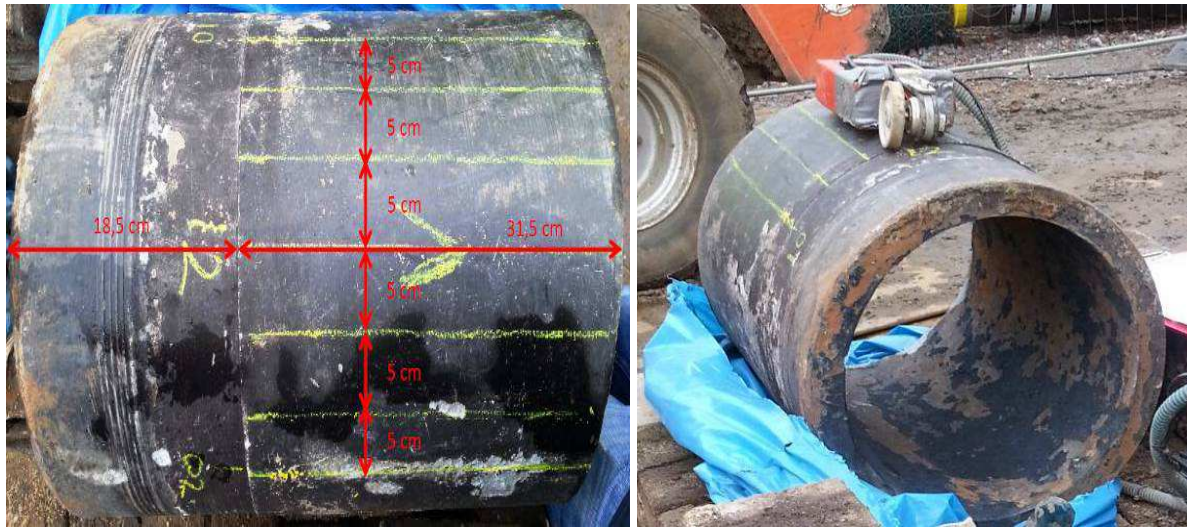
Bild 7 Bemaßte AZ-Probe (links) und Kanalradar-Prüfslitten im Einsatz (rechts)
