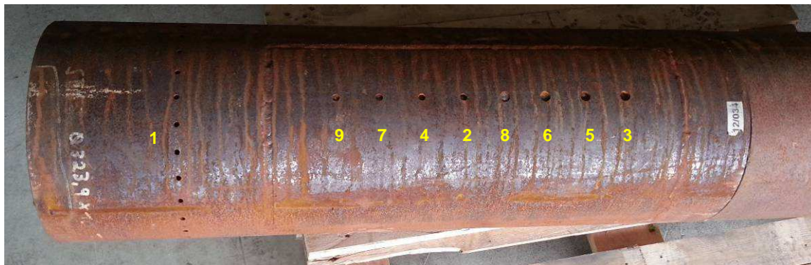
Bild 15 Präpariertes Stahlrohr der Firma KontrollTechnik GmbH mit Fehlernummern
