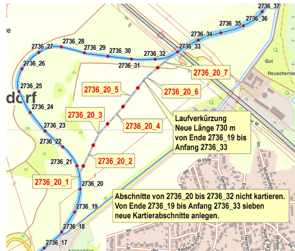
Geänderter Gewässerverlauf: Laufverkürzung
