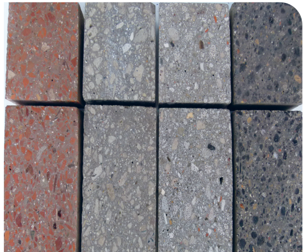
Beton mit rezyklierter Gesteinskörnung, angeschliffen
