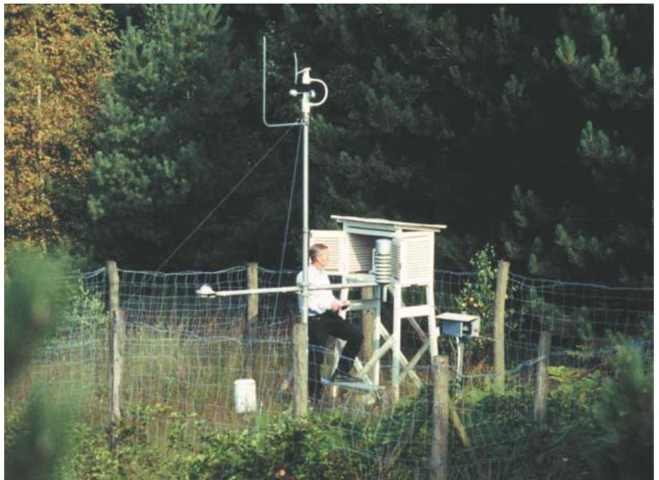
Abb. 1: Wetterstation auf Level-II-Dauerbeobachtungsfläche
