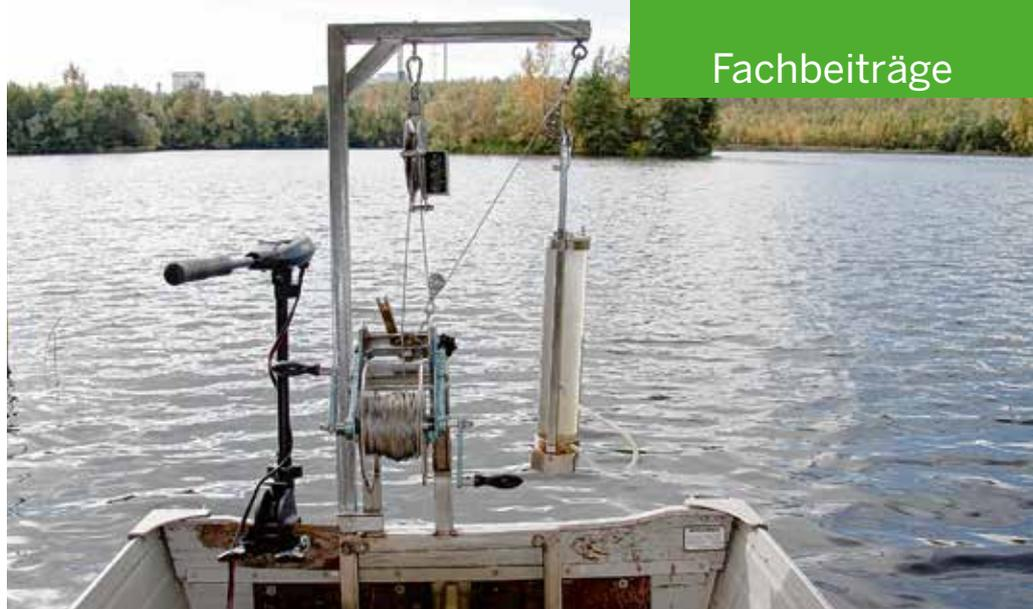
Abb. 7: Monitoring Seen: Vorrichtung zur Probenahme am Boot: Winde, Meterzähler und Wasserschöpfer. Foto: LANUV/FB 55
