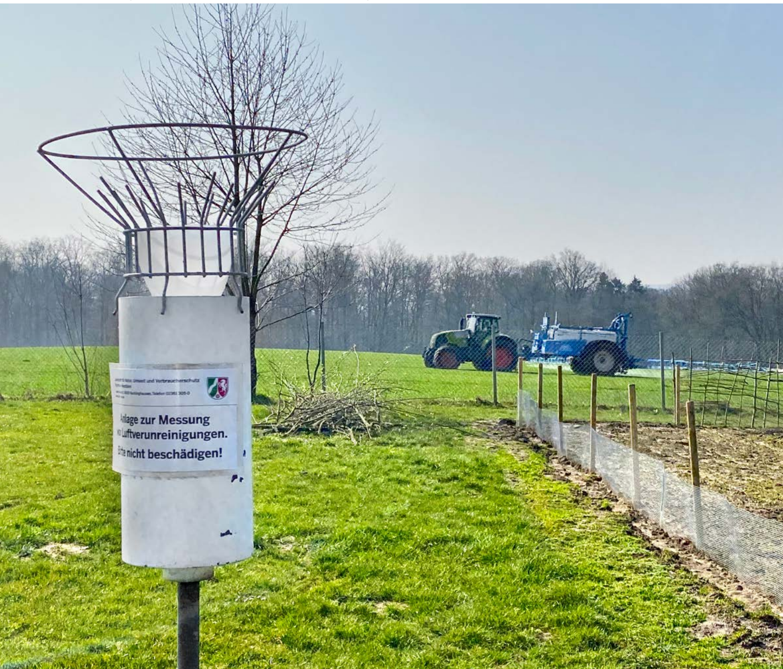
Abb. 1: Niederschlagsammler am landwirtschaftsnahen Untersuchungsstandort in Essen auf dem Gelände des LANUK. Foto: LANUK
