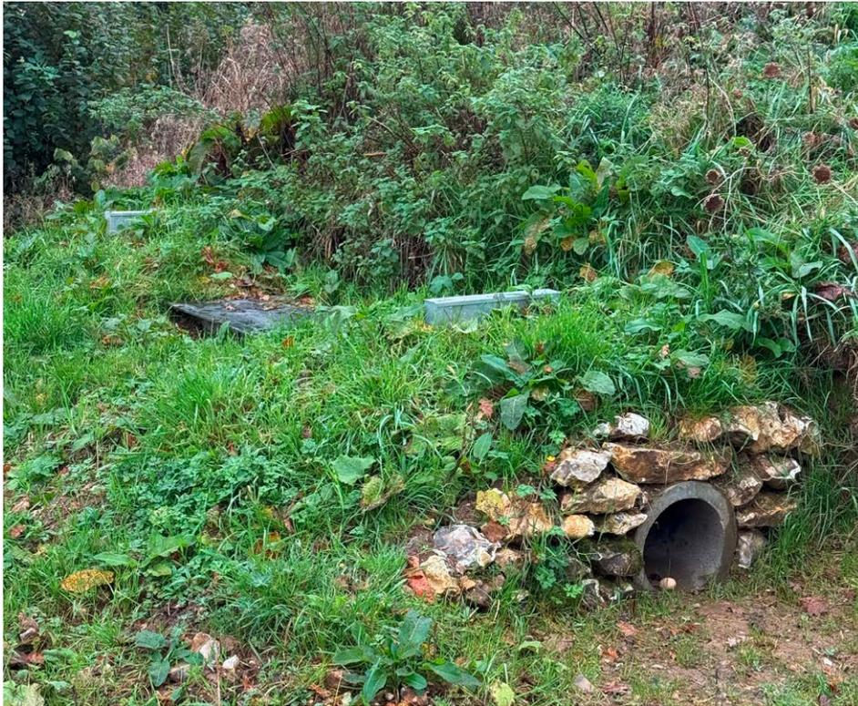
Abb. 4: Betonwipprohrfalle „Fallenfuchs“ – abschließbar eingebaut und verblendet. Foto: Firma Fallenfuchs
