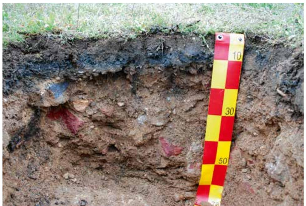
Abb. 5: Kein guter Wasserspeicher: städtischer Boden aus Kies und Bauschutt
