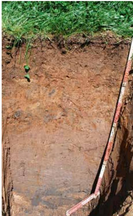
Abb. 6: Guter Wasserspeicher: natürlicher Grundwasserboden (Gley) aus Hochflutlehm
