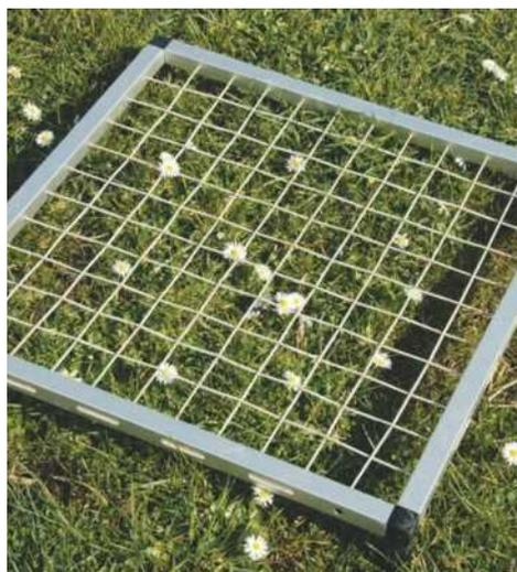
Abb. 2: Mit diesem Gitterrahmen wird die Bedeckung des Bodens erfasst
