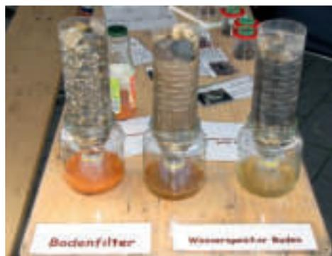
Schon mit relativ einfachen Mitteln kann die Filterwirkung und die Wasserspeicherkapazität unterschiedlicher Böden demonstriert werden. Foto: D. Schruck
