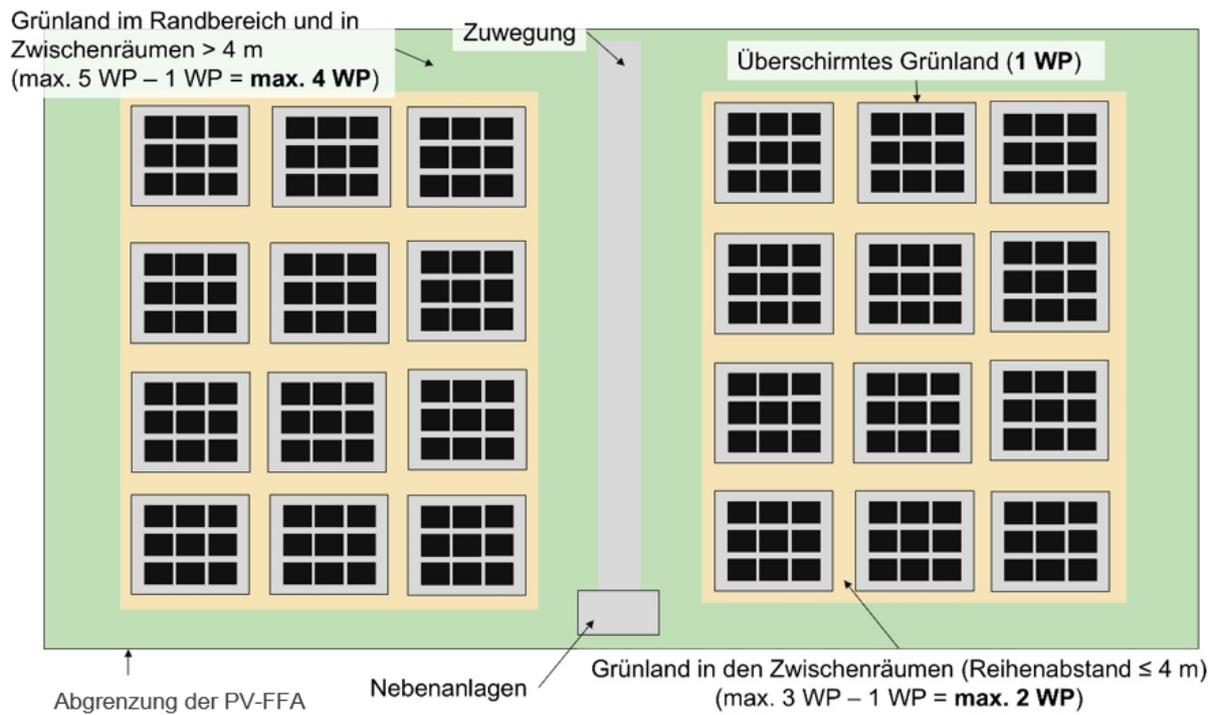
Abbildung 1: Schematische Darstellung der Bewertung einer PV-FFA mit Grünlandentwicklung im Regelfall
