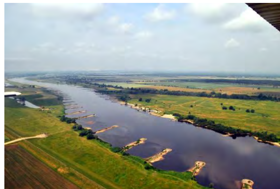
Profil mit Buhnenausbau
