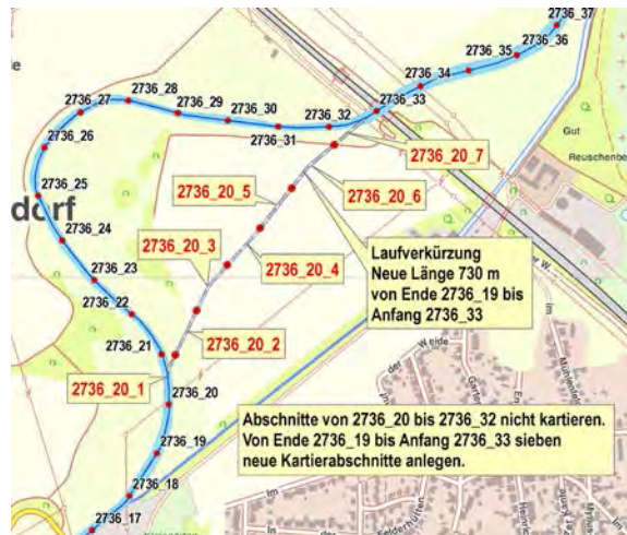
Geänderter Gewässerverlauf: Laufverkürzung
