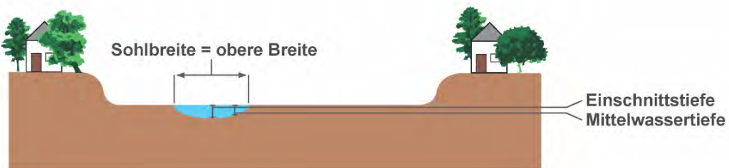
Abbildung: Gewässer in Sekundäraue fließend
