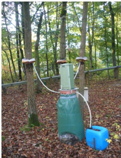
**Abbildung 11:** Gummimanschetten an den Baumstämmen und Sammeltonne mit Schreibpegel für stammablaufenden Niederschlag unter Wald
