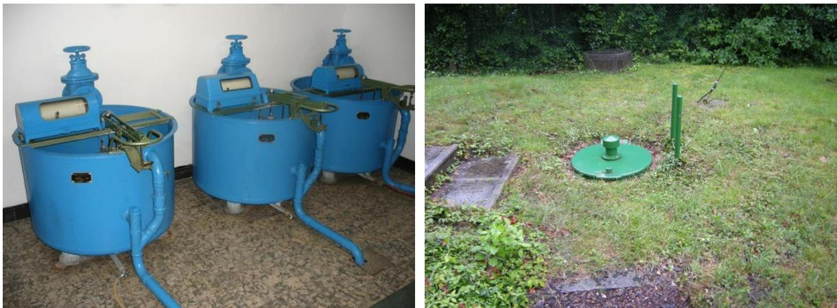
**Abbildung 6:** Messkeller mit Auffangbecken für Sickerwasser (links), Versickerungsschacht (rechts)
