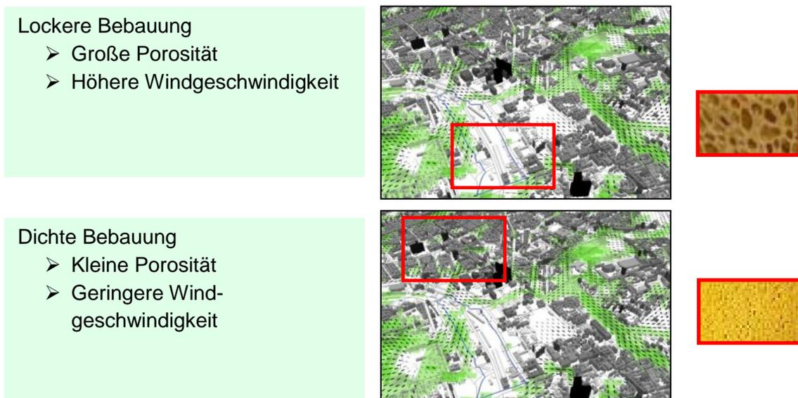
**Abbildung 7:** Einfluss der Bebauungsdichte auf die Strömungsgeschwindigkeit
