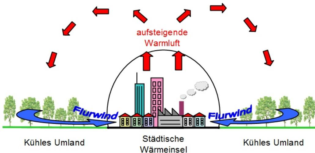
**Abbildung 4:** Prinzipskizze Flurwind
