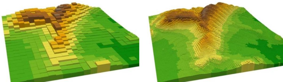
**Abbildung 6:** Unterschiedliche Rasterweiten bei einem digitalen Geländehöhenmodell (links: 500 m x 500 m; rechts: 100 m x 100 m)
