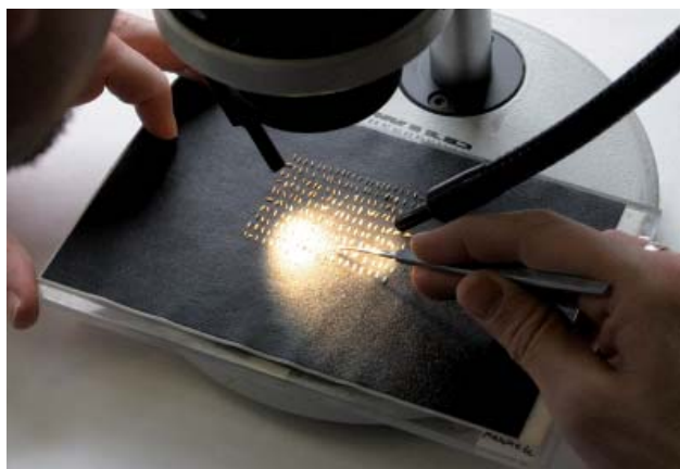
Unter dem Mikroskop wird geprüft, ob sich Samen anderer Arten in dem Saatgut befinden
