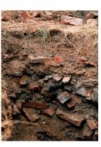
Der naturnahe Boden links kann auf einem Quadratmeter Fläche rund 250 Liter Wasser für Pflanzen verfügbar speichern, der Bauschuttboden rechts dagegen nur 150 Liter.
