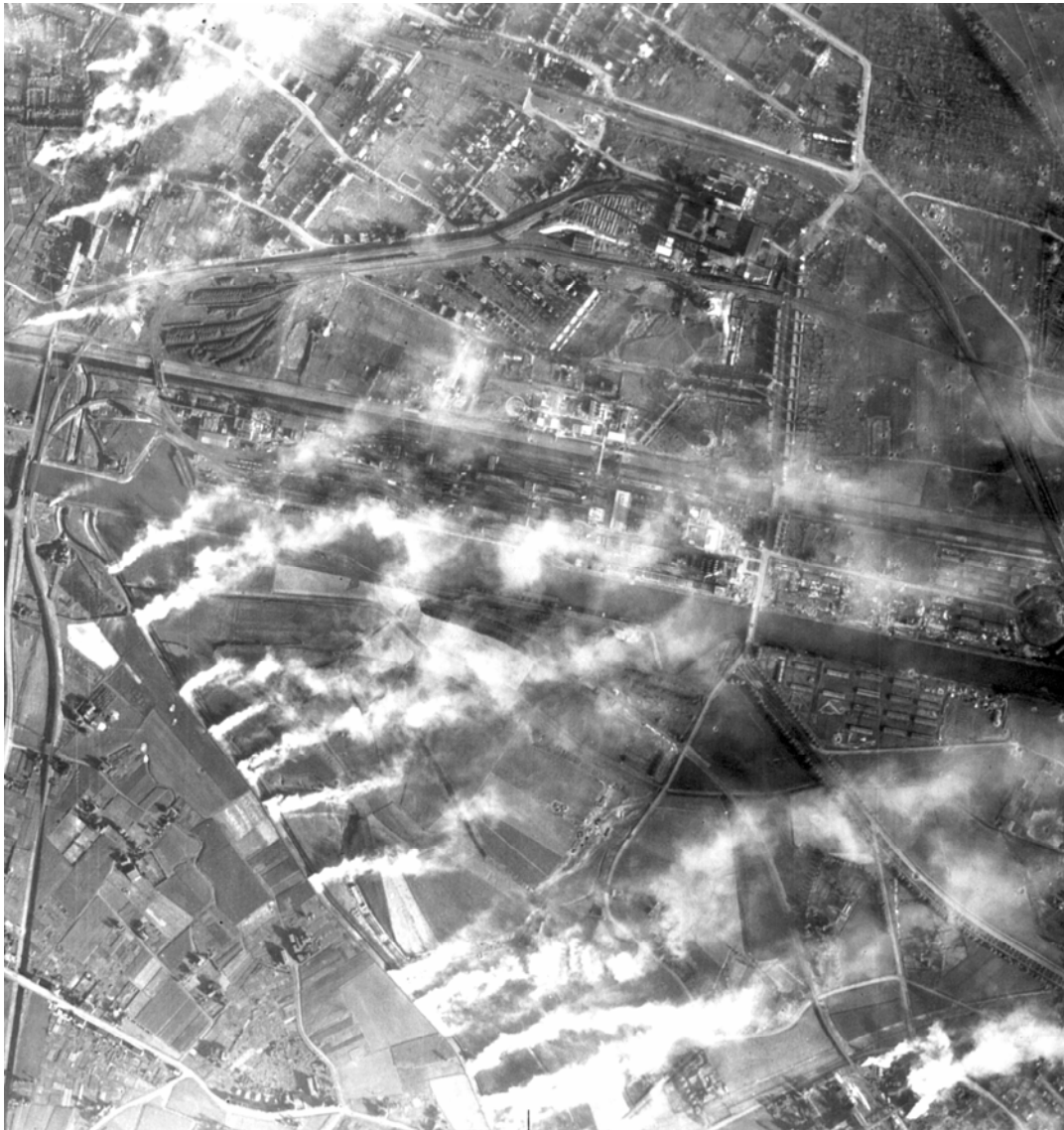
Abbildung 3: Nebelschutzanlage im Bereich der Zeche und Kokerei Nordstern. Der Ausschnitt aus einem Senkrechtsbild der RAF-Aufklärung vom 28. Juni 1944 zeigt das Zechen- und Kokereigelände Nordstern, Gelsenkirchen. Der Anlagenschwerpunkt befindet sich auf der „Insel“ zwischen Emscher und Rhein-Herne-Kanal (Bildmitte). Sehr deutlich zeichnet sich die Konfiguration der Nebelschutzanlage ab. Zum Aufnahmezeitpunkt besteht noch keine geschlossene Nebeldecke; um so deutlicher treten die Einzelkomponenten der Anlage hervor. (Luftbild: Archiv des LfAO, Düsseldorf)
