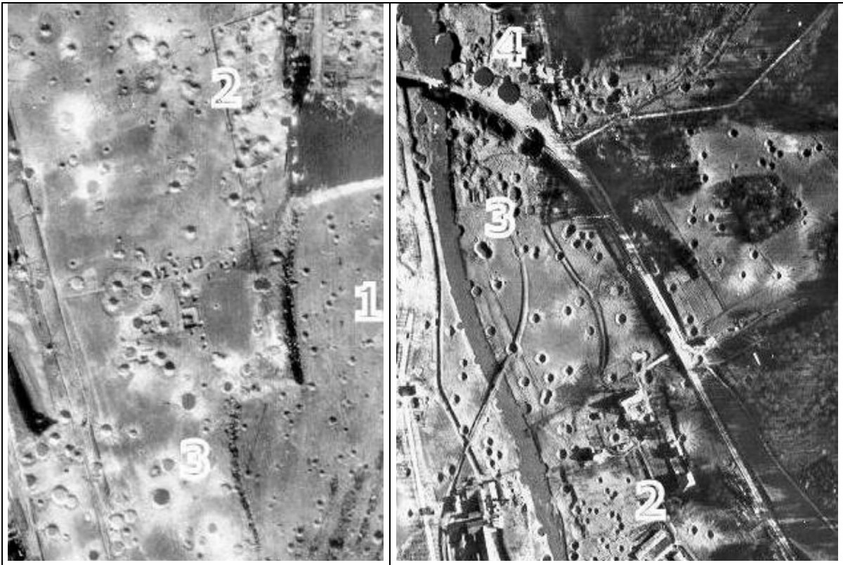
Abbildung 23: Erscheinungsbild von Bombentrichtern in Abhängigkeit vom Kaliber. Namentlich im unbebauten Gelände sind unschwer die – je nach Kaliber der abgeworfenen Bomben – unterschiedlich großen Bombentrichter zu erkennen und auszumessen, hier: Durchmesser bei (1) = 2 – 3 m, bei (2) = 4 – 6 m, bei (3) 8-12 m und bei (4) rund 30 m; mittlere Maßstäbe der Luftbilder im Original: 1:10 000 (links), 1:8 000 (rechts). Bilder: Archiv des LAfAO, Düsseldorf
