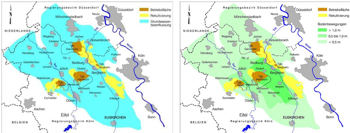
Abbildung 2: Ausdehnung der a) Grundwasserabsenkung und b) Bodenbewegungen (RWE Power AG, 2017).
