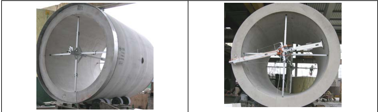
Abbildung 3: eingerichtetete Messtechnik in einem Vortriebsrohr DN 2600
