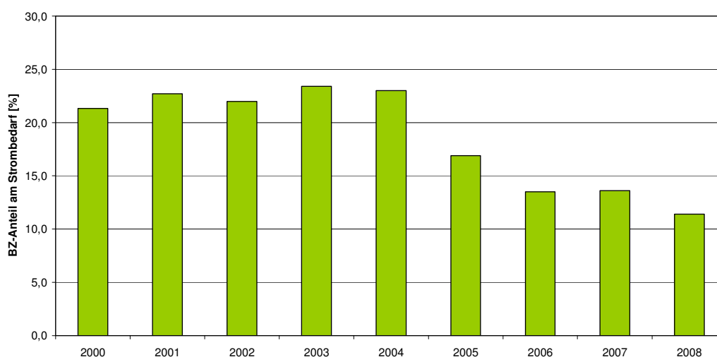
Anteil Stromerzeugung der Brennstoffzelle am Gesamtbedarf in den Jahren 2000 bis 2008 Kläranlage Köln-Rodenkirchen
