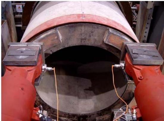
*Bild 143* Vorsprezstation des Vortriebssimulators
