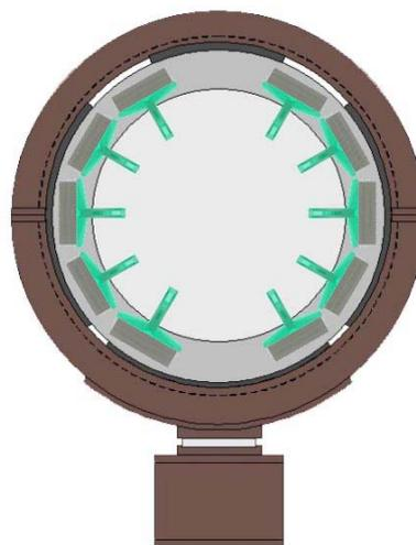
*Bild 106 Druckmessfolien in der Rohrfuge*
