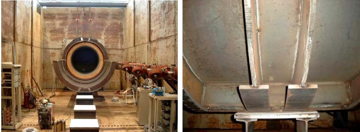
*Bild 96 Rohraufleger mit Teflonplatten*
