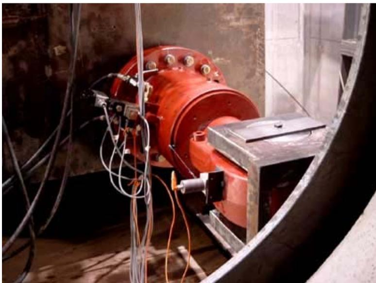
*Bild 93 Anschluss Vorpresszylinder - Druckring*
