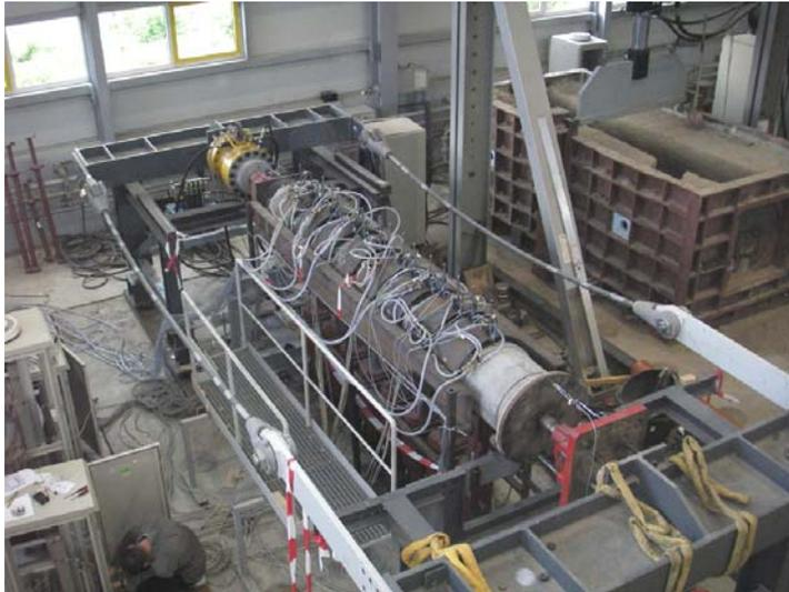
**Bild 27** Gesamtansicht des Vortriebssimulators, Modell DN 400
