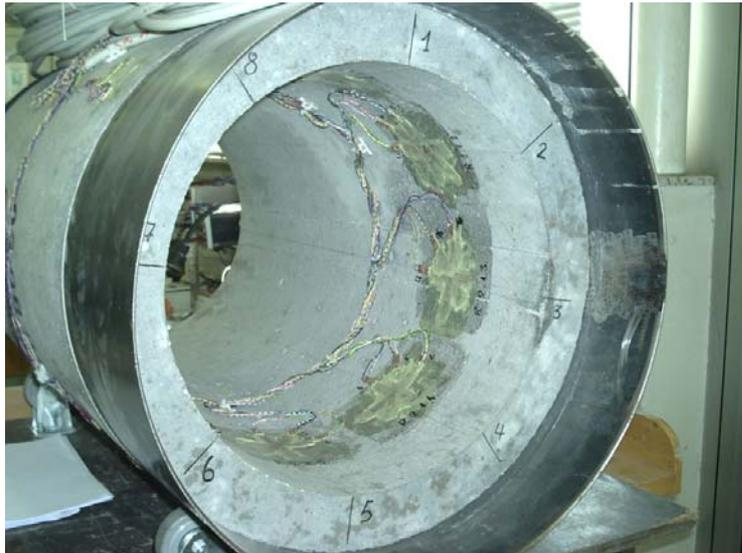
Bild 32 Versuchsrohr DN 400 mit Dehnungsmessstreifen
