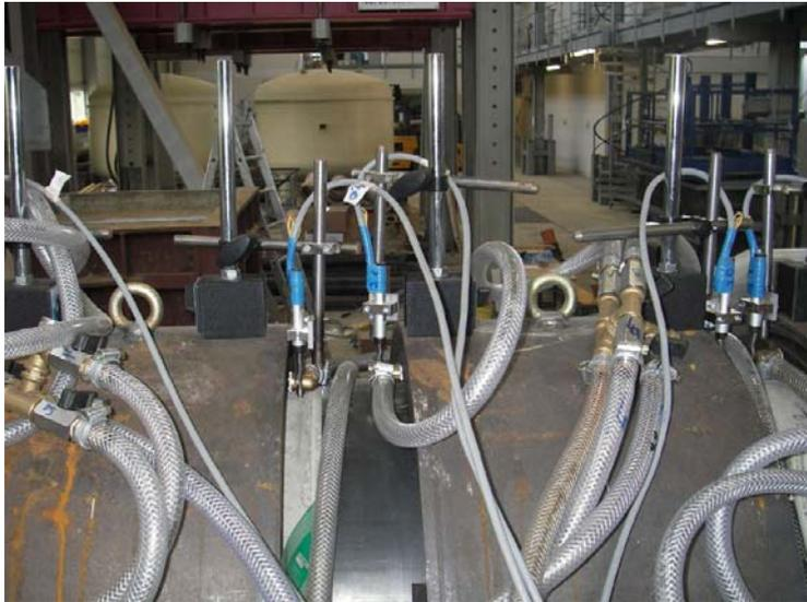
*Bild 30 Wegaufnehmer zur Erfassung der Relativverschiebung zwischen Stahlring und Vortriebsrohr*
