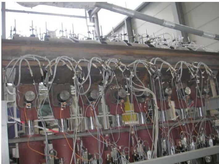
**Bild 29** Hydraulikzylinder zur Positionierung der Vortriebsrohre (Kurvenfahrt)
