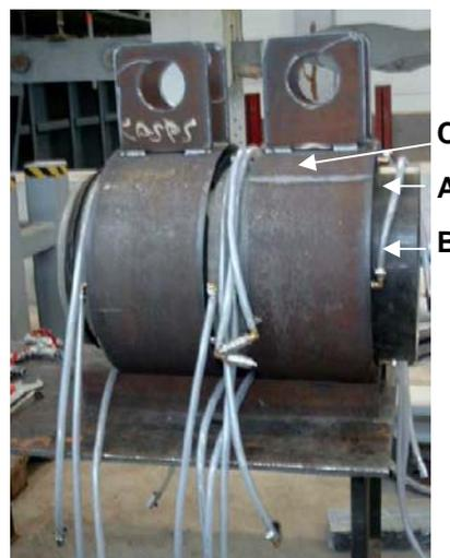
Legende: A: Vortriebsrohr / B: Druckkissen / C: Stahlring
