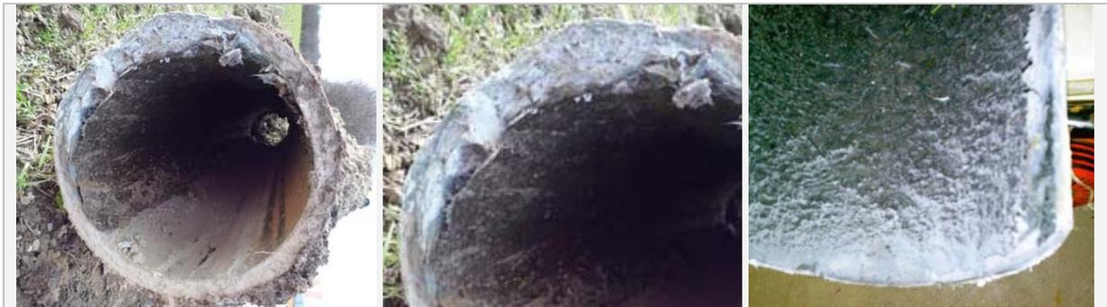
Abb. 7: Gequollenes Asbestzementrohr einer Abwasserdruckleitung (links, mittig) [16] und Ausschnitt eines korrodierten Asbestzementrohres einer Abwasserdruckleitung [15] (rechts)
