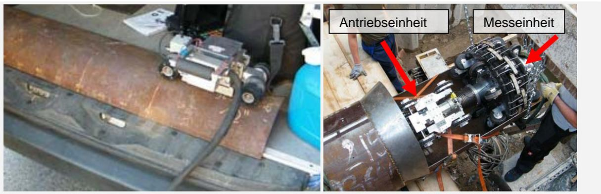
Abb. 10: Wirbelstromprüftechnik zur Außen-Inspektion (li) und Inspektionsroboter mit Wirbelstromprüfeinheit zur Innen-Inspektion (re)
