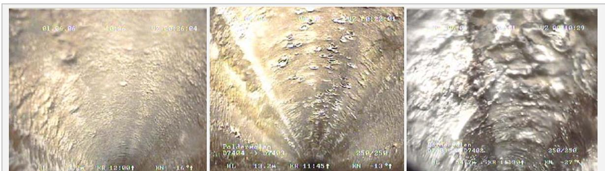
Abb. 8: Blasenbildung (links, mittig) und Ablösen von Material (rechts) der Rohrwand einer Trinkwasser-Asbestzementleitung [17]
