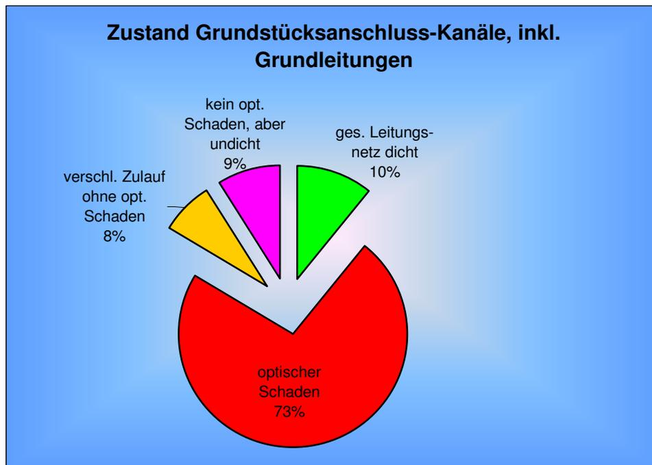
Abb. 16: Zustand der Grundstücksanschlusskanäle inkl. Grundleitungen
