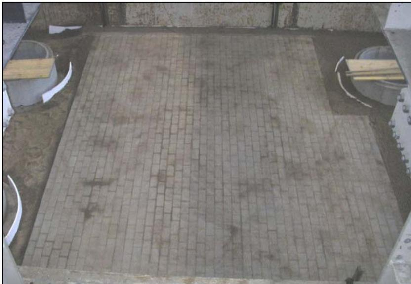
Bild 24 Fertiggestellte Pflasterfläche im IKT-Großversuchsstand
