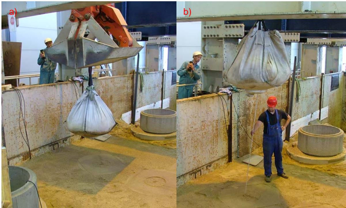
Bild 57 Fallversuche im IKT-Großversuchsstand mit einer Fallhöhe von a) 1,0 m und b) 2,0 m
