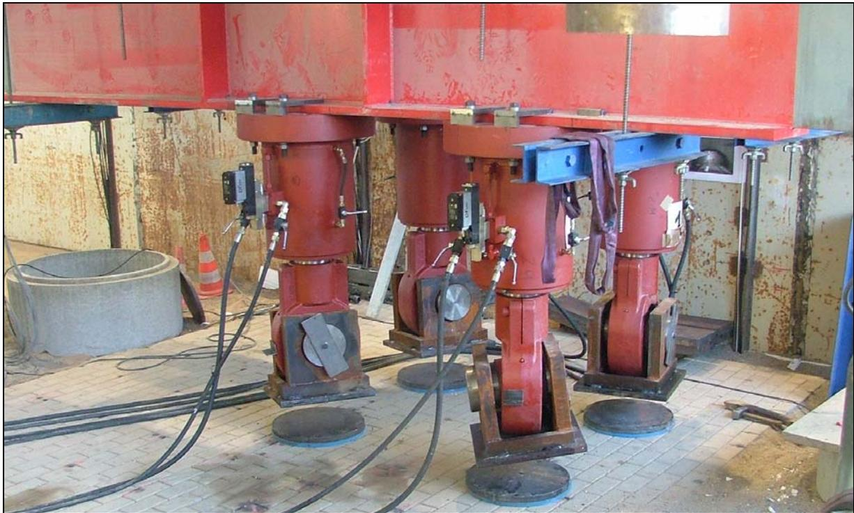
*Bild 43 Lasteinleitungsstruktur für den Lastfall „Radgruppe statisch“*
