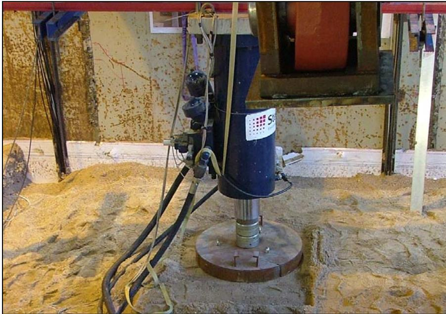
Bild 56 Lasteinleitungs-konstruktion beim Lastfall „Einzelrad statisch - Bauzustand“ über dem Guss-, Beton- und Kunststoff-Rohrstrang (hier: Pflasterseite nach Ausbau des Pflasters)
