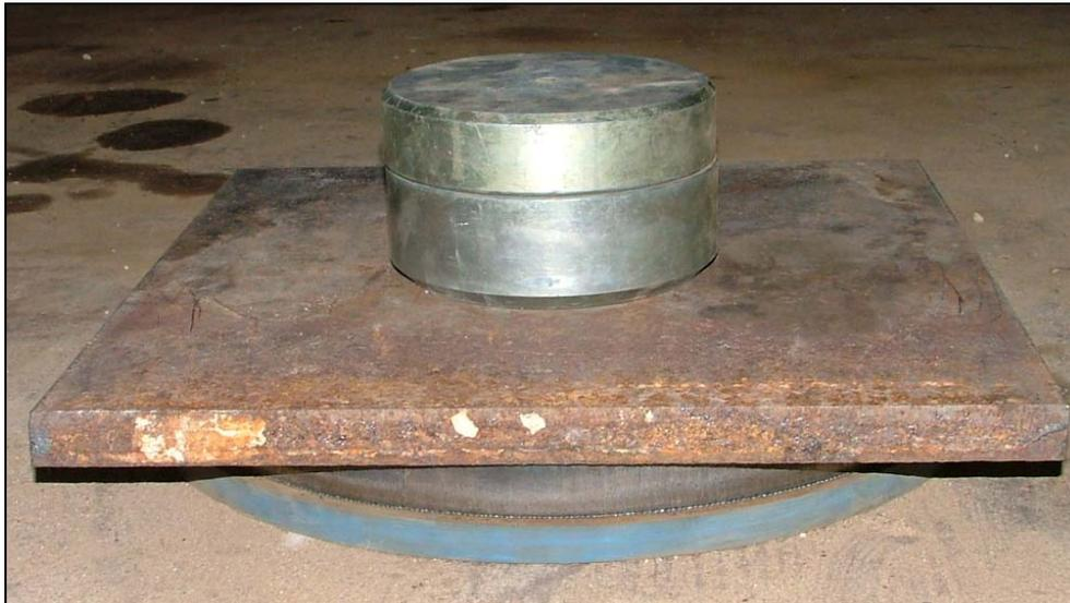
Bild 40 *Lasteinleitungsstruktur beim Lastfall „Einzelrad statisch“ über dem Guss- und Beton-Rohrstrang (hier Lastplattenseite)*
