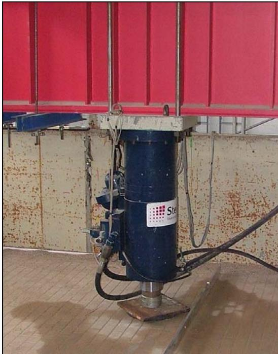
*Bild 27      Hydraulikzylinder zur Einleitung von statischen und lastzyklischen Einzelradlasten*
