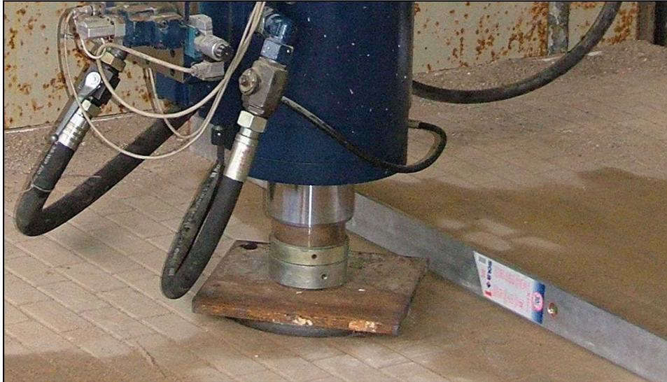
Bild 41 Lasteinleitungskonstruktion beim Lastfall „Einzelrad lastzyklisch“ (hier Pflasterseite)
