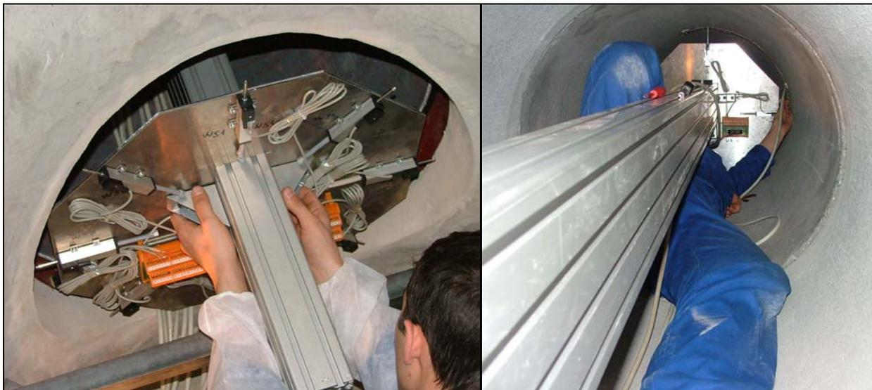
a) Montage einer Messtafel an der Messbrücke
