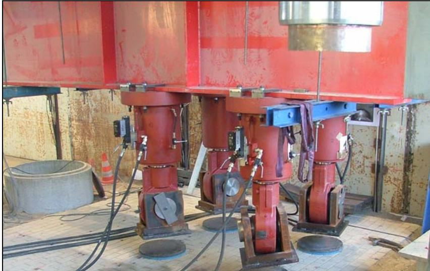
*Bild 28      Hydraulikzylinderkonstruktion zur Einleitung von 4 statischen Radlasten*
