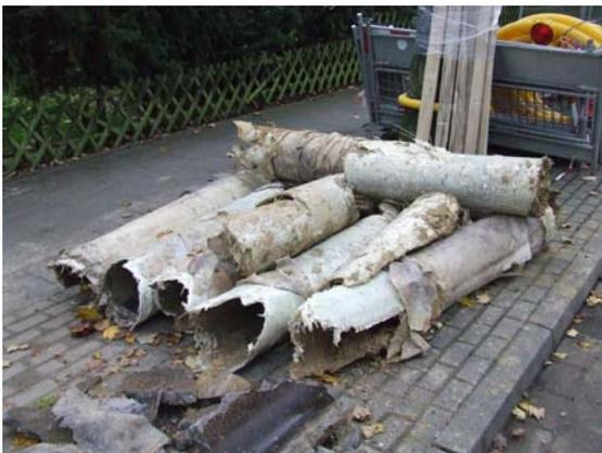
a) Altrohre und Schlauchliner, DN 300, Beton, GFK-UP-Liner
