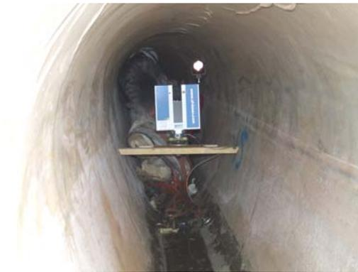
a) Positionierung des Scanners im Kanal
