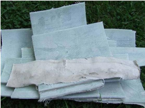
c) Material aus dem Schacht, Probekörper und Jeansschlauch
