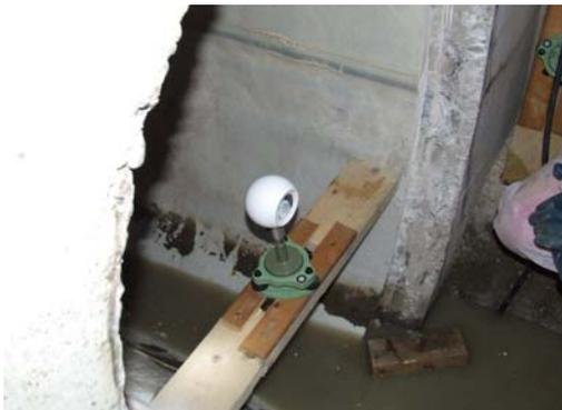
b) Kugelprisma zur tachymetrischen Einmessung des Scanners
