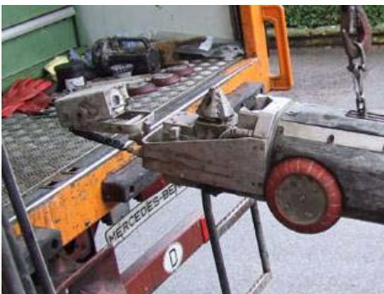
a) Kanalroboter mit Fräskopfaufsatz zur Entnahme von Haltungsproben
