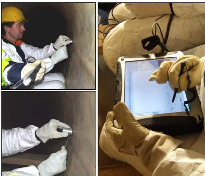
Abb. 65: Durchführung des Impakt-Echo-Verfahrens im Kanal
