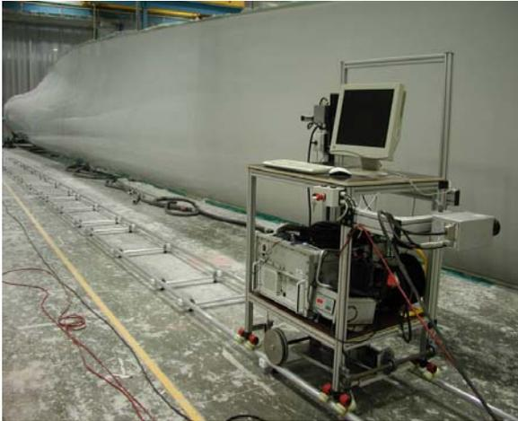
Abb. 27: Prüfung eines Rotorblattes mittels Wärmefluss-Thermographie [118]
