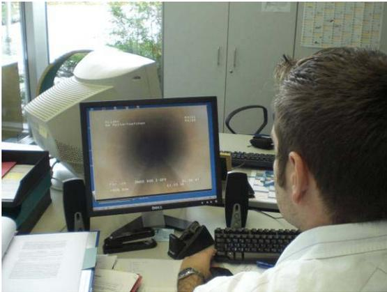
a) Auswertung eines Inspektionsvideos zur Auswahl der Entnahmestellen
