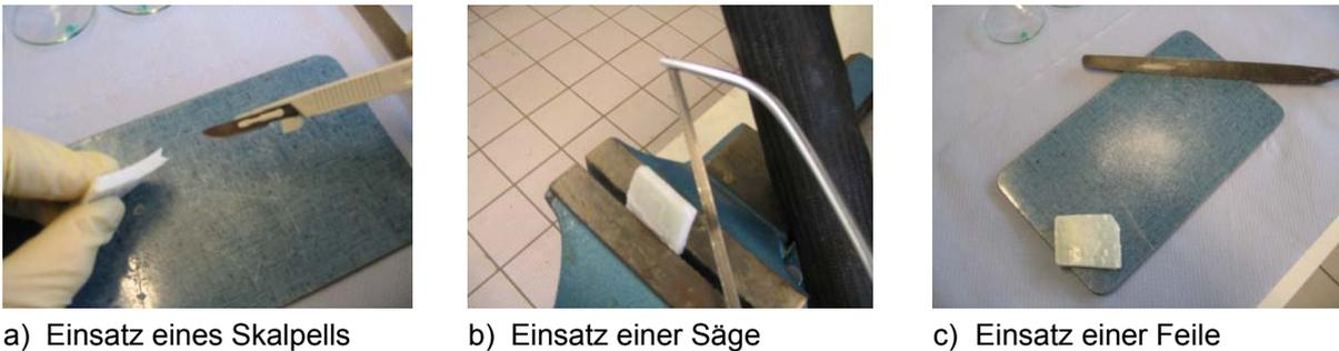
Abb. 117: Präparation einer Linerprobe mit einem Skalpell, einer Säge und einer Feile
