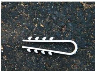
b) Dübel zur Befestigung der Messkabel an der Altrohrwand
