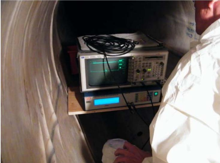
Abb. 79: Labor-Set-Up bei den Messungen im Kanal; oben Oszilloskop, darunter Pulser-Receiver
