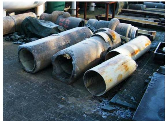
b) Altrohre und Schlauchliner, DN 500, Beton, NF-UP-Liner
