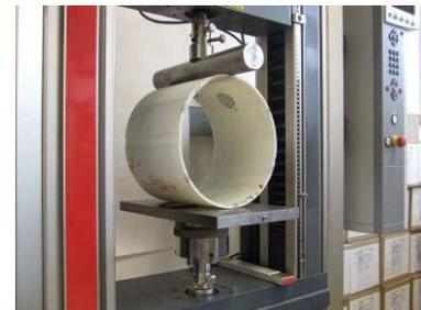
c) Scheiteldruckversuch in Anlehnung an DIN EN 1228
