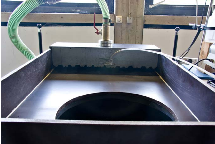
Abbildung 5: Versuchsläche mit Anschlussplatte für die Wasseraufgabe und installiertem Spritzschutzblech
