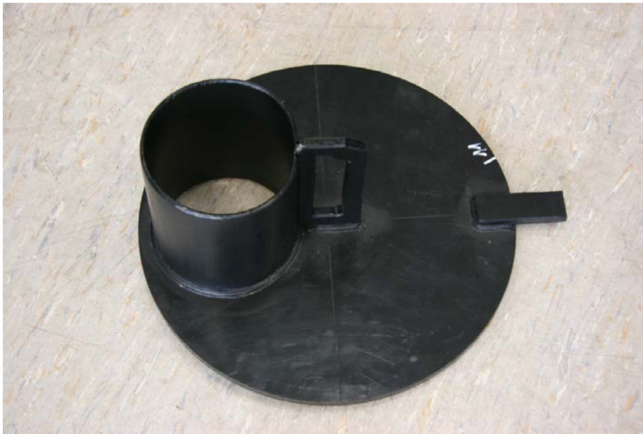
Abbildung 30: Einzelne Kreisschale des Nassschlammfangs mit Griff zur Entnahme mittels Hakenstab
