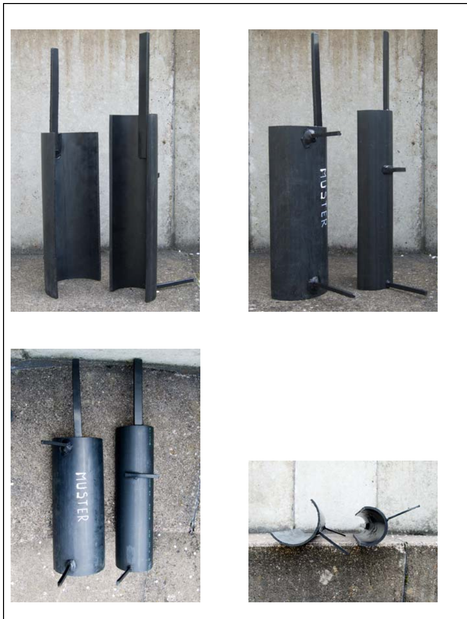
Abbildung 10: Unterschiedliche Ansichten zweier Varianten des Einbaus zur Erzwingung einer Strömungsumlenkung in der 2. Kammer des Centrifuel-Systems; links Variante 1, rechts Variante 2
