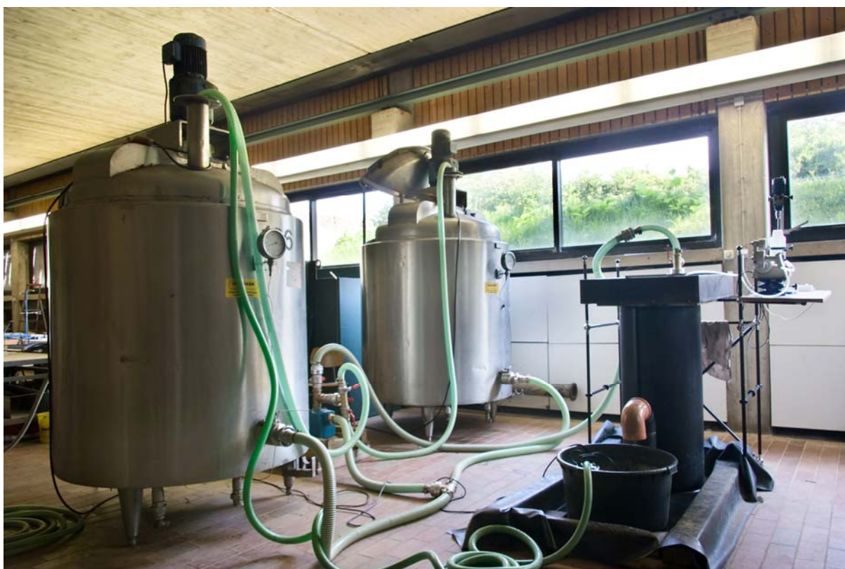
Abbildung 2: Prüfstand mit Vorlagebehältern, Pumpen sowie Centrifuel-System mit Aufsatz
