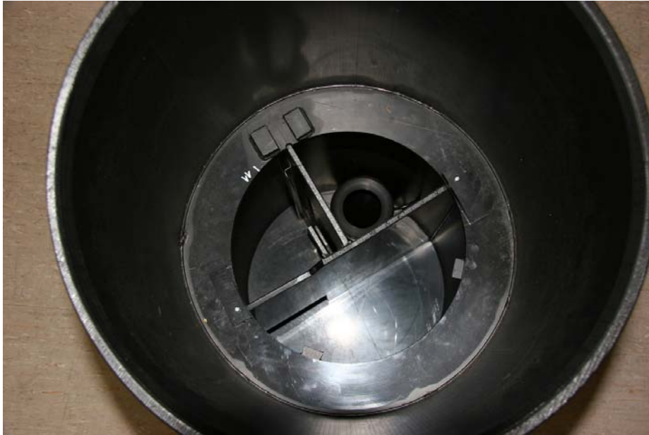
Abbildung 31: Blick in die unteren drei Kammern des neuen Centrifloel-Systems (Ventilkugel wurde entnommen)
