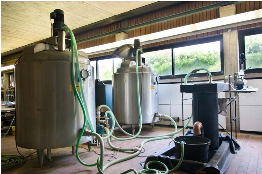
Abbildung 2: Prüfstand mit Vorlagebehältern, Pumpen sowie Centrifloel-System mit Aufsatz
