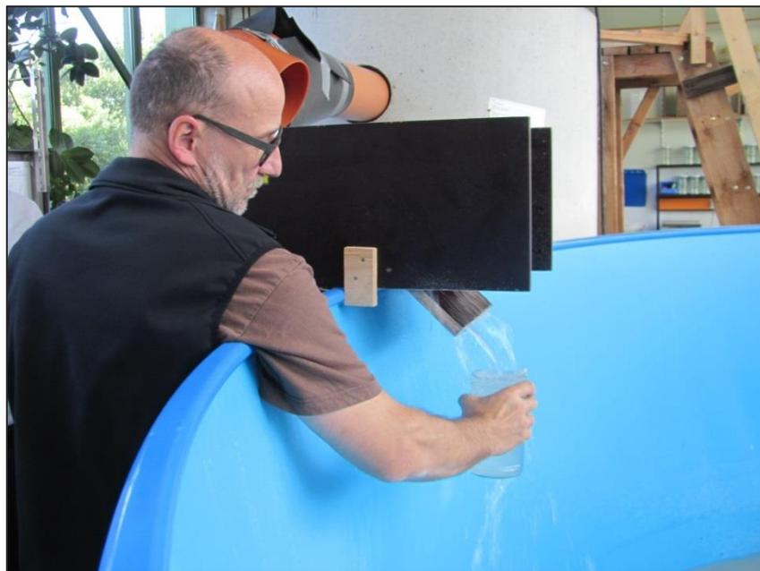
Bild 2-6: Probennahme am Ablauf
