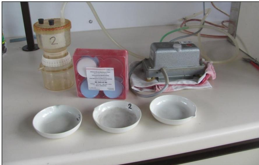
Bild 2-8: Filtrationseinheit mit Filtern und Tiegeln
