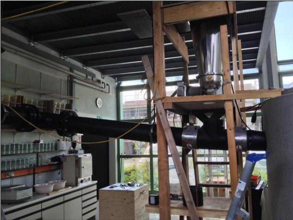
Bild 2-2: Versuchstand mit der Zulaufführung, dem Millisildosierer und der Anlage (rechts)
