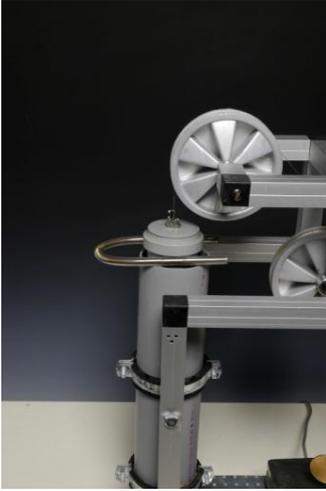
Zunächst den äußeren Zylinder mit Wasser befüllen. Dadurch schwimmt der innere Kolben auf und kann mit der Fixierung am Rand des äußeren Zylinders befestigt werden. Der Wasserstand sollte bis ca. 1 cm unter den Rand des äußeren Zylinders reichen.
