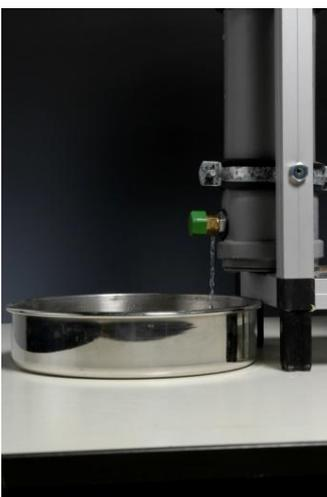
Nach dem Trieren der Waage wird der Auslasshahn im unteren Bereich des äußeren Zylinders geöffnet. Das Wasser aus dem äußeren Zylinder strömt in die Auffangschale.
