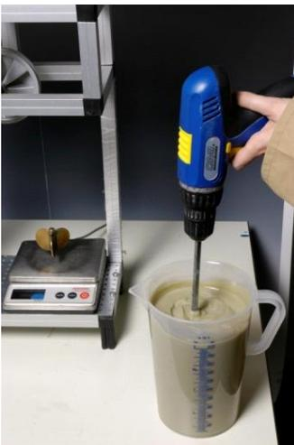
Für die Durchführung der Versuche werden 2.000 cm<sup>3</sup> (alternativ 1.500 cm<sup>3</sup>) der zu untersuchenden Suspension in einen geeigneten Probenbehälter gefüllt. Im Anschluss daran wird die Suspension ca. 30 Sekunden mit einem geeigneten Rührwerk durchmischt.
