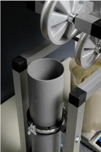
Durch den sinkenden Wasserspiegel im äußeren Zylinder sinkt der innere Kolben ab und zieht dabei das Pendel in der Suspension nach oben. Dadurch wird die Scherfestigkeit der Suspension mobilisiert. Dies zeigt sich an einer negativen Grammanzeige auf der Waage.
