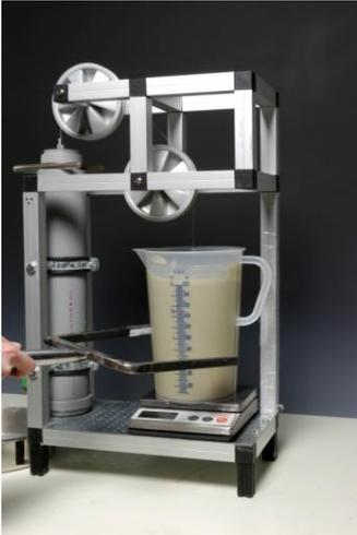
Mit Hilfe der Schlaggabel wird durch dynamische Anregung des Probenbehälters ein vollständiges Absinken des Pendels in die Suspension sichergestellt.
