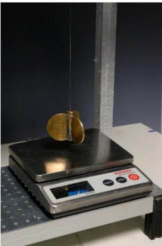
Durch das Aufschwimmen des Kolbens sinkt das Pendel über der Waage ab. Es sollte ca. 2 cm oberhalb der Waage hängen. Ist dies nicht der Fall, sollte der Faden entsprechend gekürzt oder verlängert werden.
