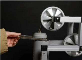
Im nächsten Schritt wird die Sicherung des Kolbens gezogen und die Waage tariert. Vor dem Zurücksetzen der Waage wird die Gewichtsanzeige (abzüglich des Gewichts des Probebehälters) abgelesen, um anschließend die Wichte der Suspension bestimmen zu können.
