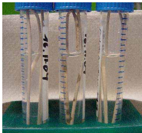
Abbildung 4-2: Versuchsansatz im Labor zur Elution von Hohlfasern in Chemikalien. Die Membranen in Lösung (10-15 ml) wurden in den Röhrchen für 24h in horizontaler Lage geschüttelt. Deutlich ist die Verfärbung der Membranen im mittleren Röhrchen zu erkennen.
