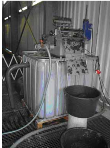
Abbildung 8-20: Installation eines 1mm Lochsiebrechens im August 2005
