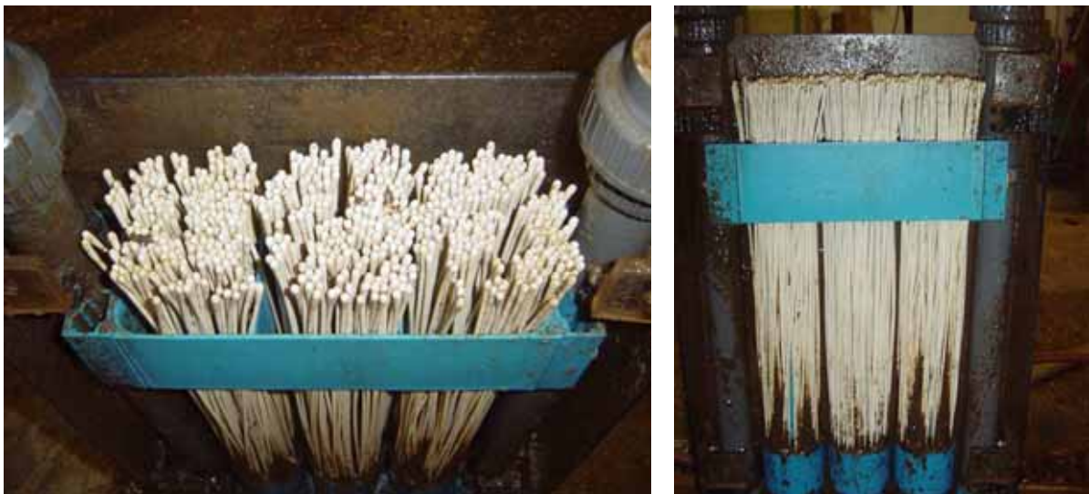
Abbildung 8-57: Membranen der Referenzanlage 30 d am 17.10.06 vor der Reinigung.
