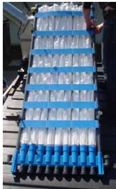
Abbildung 8-23: PURON®-Modul Prinzip, Membranmodul der Pilotanlage
