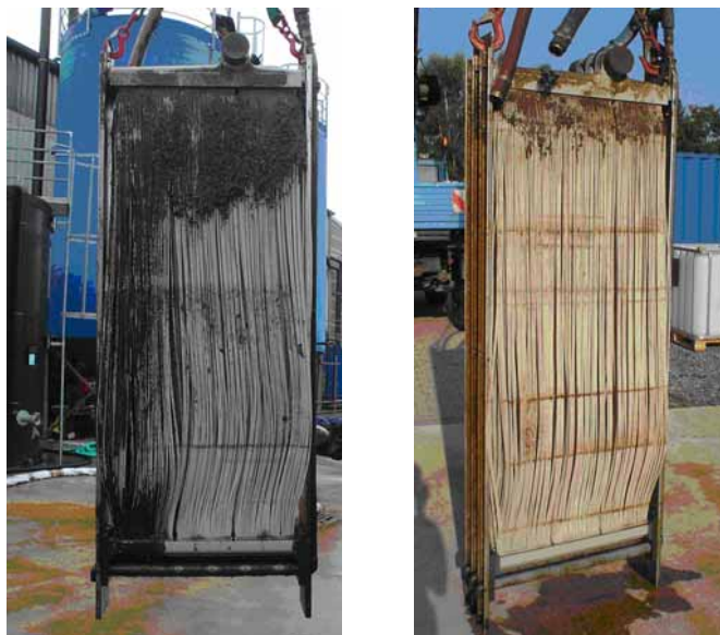
Abbildung 8-21: ZENON®-Modul ohne (links) und Modul mit (rechts) Vorsiebung des BS
