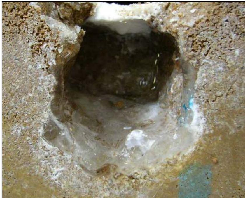
**Abbildung 4-13: Abdichtungsgebilde nach Rohrausbau**
