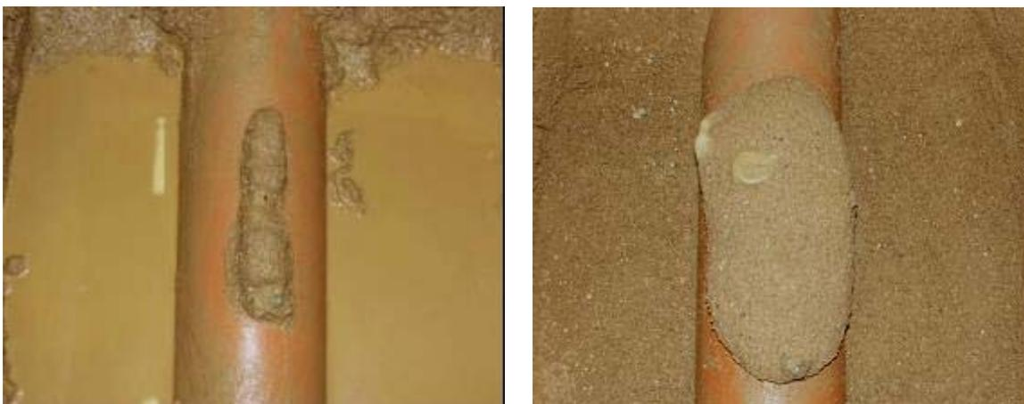
**Abbildung 4-11: Abdichtungskörper in wassergesättigtem (links) und erdfeuchtem (rechts) Boden**
