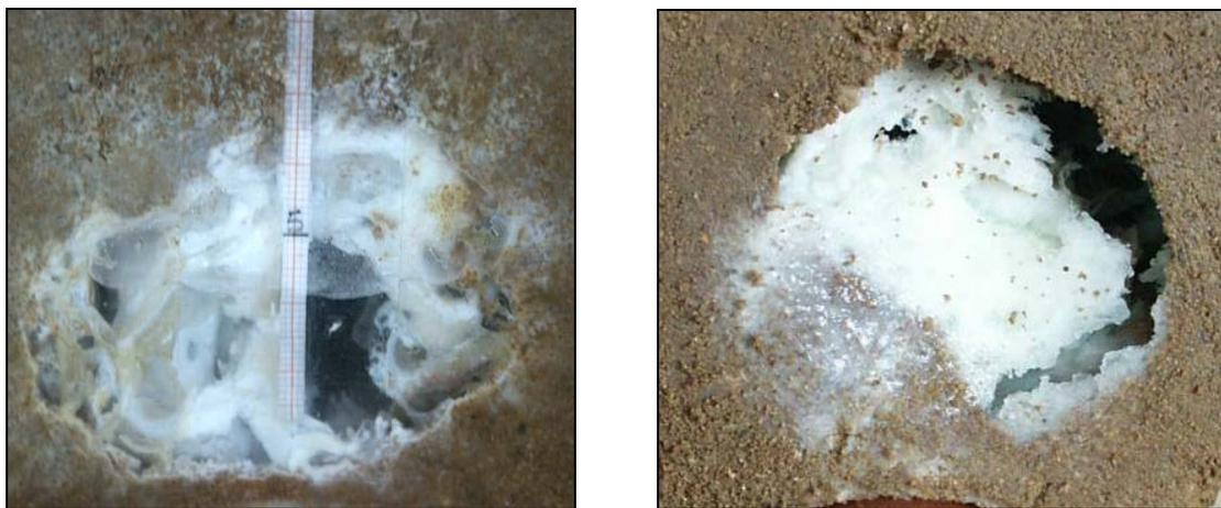
**Abbildung 4-12: Abdichtungsgebilde nach Sanierung (links) und Aushärtung (rechts)**
