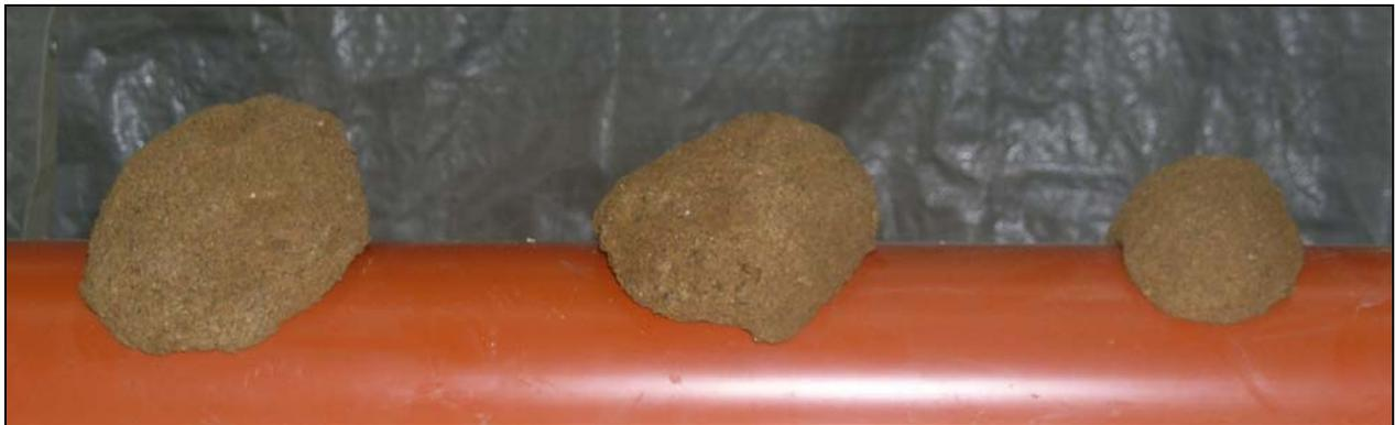
**Abbildung 4-16: Abdichtungskörper bei niedrigen Injektionsdrücken (0,035 / 0,020 / 0,005 bar)**
