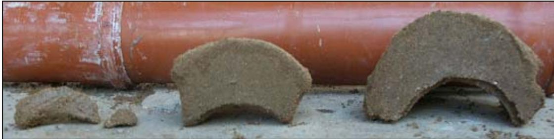
**Abbildung 4-8: Abdichtungskörpergrößen bei unterschiedlichen Lagerungsdichten**
