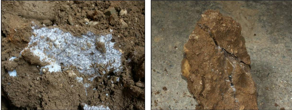
**Abbildung 4-9: Strukturstörungen bei Abdichtungskörpern in gemischtkörnigem Boden**
