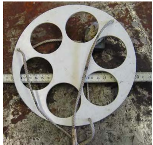
Abb. 6.2-11: Modifizierte Secchi-Scheibe zur Bestimmung der Sichttiefe
