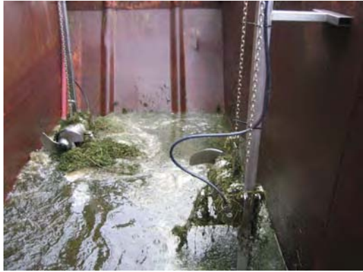
Abb. 6.14-4: Versuchsanordnung zur Zerkleinerung von Elodea in wässriger Phase
