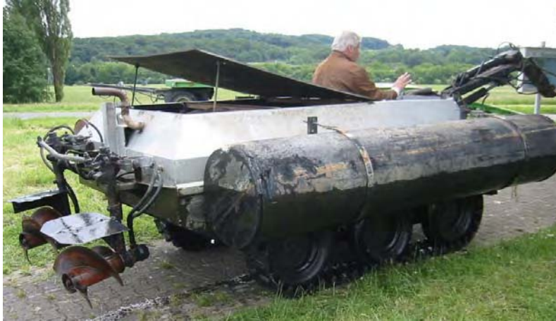
Abb. 6.12-5: Sturm-Boot mit Turbulenzen erzeugenden Wellen am Heck
