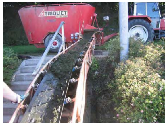
Abb. 6.14-6: Futtermischwagen mit Gurtbandförderer zum Elodea -Austrag
