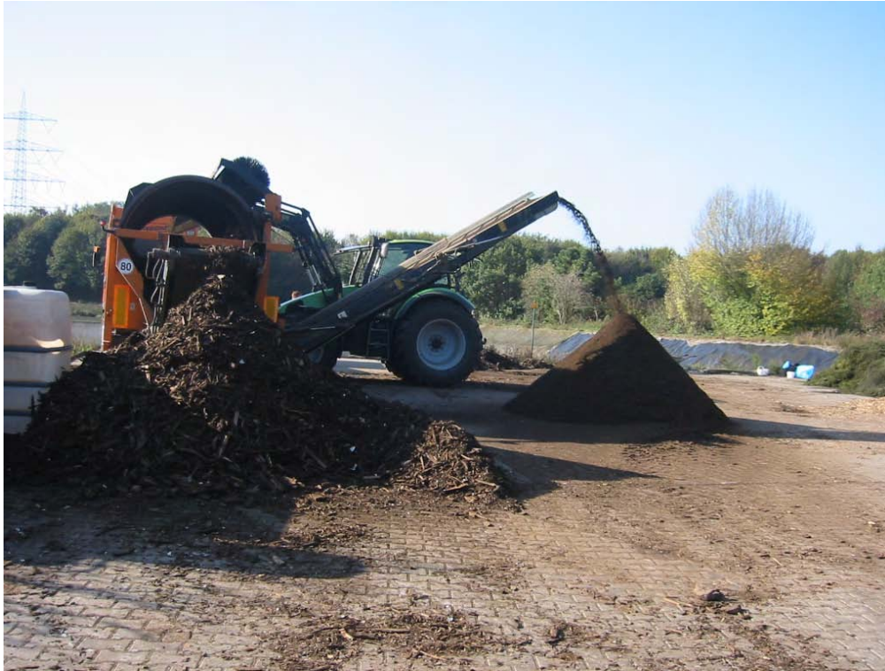
Abb. 6.13-7: Absiebung der Kompostmiete (Versuch 1) mittels Trommelsieb (Lochdurchmesser 8mm) nach 43 Tagen
