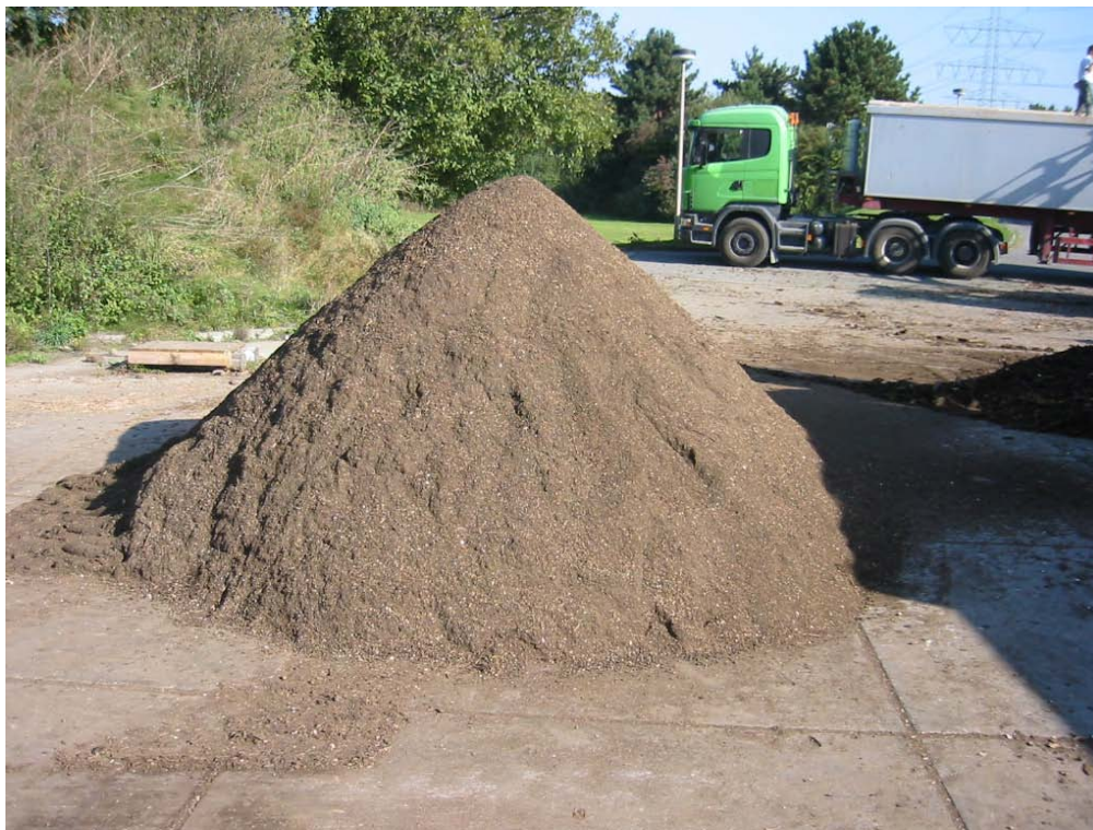
Abb. 6.13-9: Absiebung der Kompostmiete (Versuch 1) nach 43 Tagen - Unterkorn < 8mm
