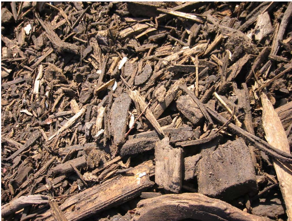
Abb. 6.13-8: Absiebung der Kompostmiete (Versuch 1) nach 43 Tagen - Überkorn > 8mm (Detailaufnahme)
