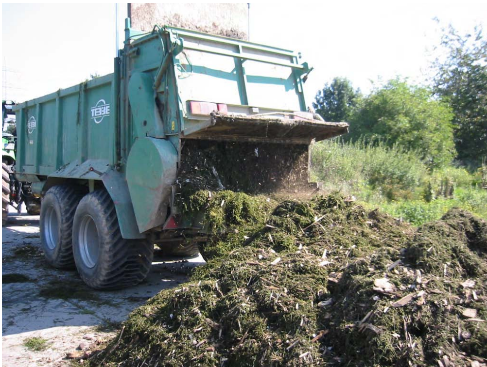
Abb. 6.13-4: Eingesetzte Mischtechnik, modifizierter mobiler Klärschlammstreuer Fabr. TEBBE
