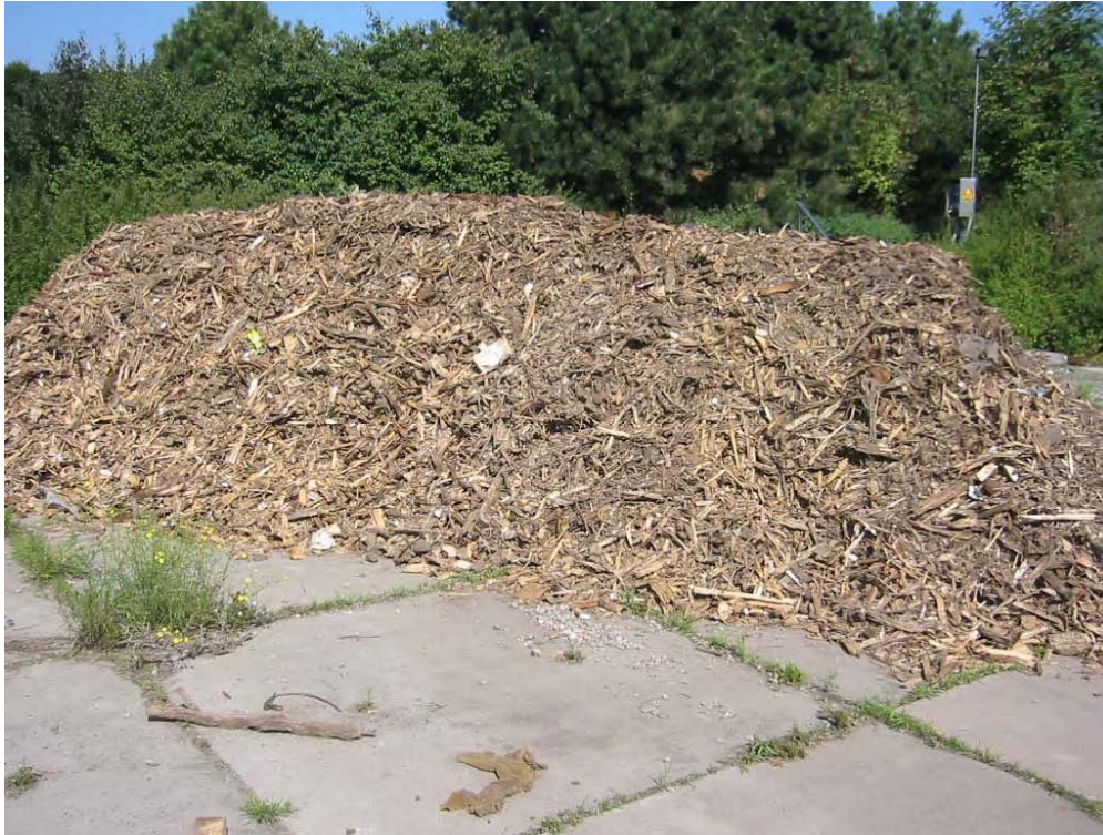
Abb. 6.13-3: Eingesetzte Materialien; geschreddertes Altholz
