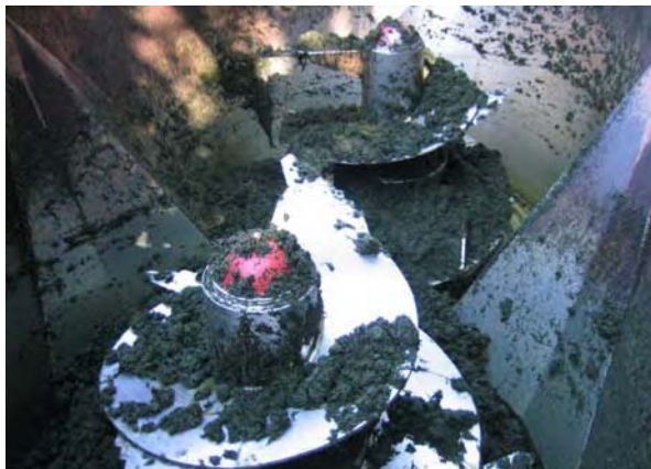
Abb. 6.14-5: Futtermischwagen mit vertikalen Schneidmischschnecken
