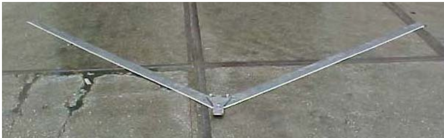
Abb. 6.12-3: Schleppsense aus Stahl
