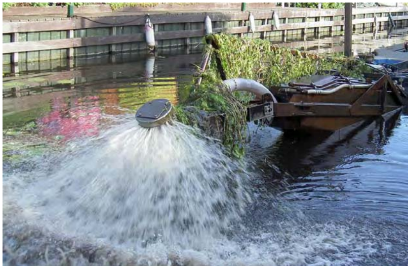
Abb. 6.12-4: Boot mit Hochdruck-Spülkopf
