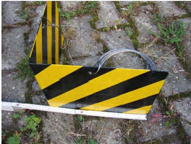
Abb. 6.4-2: Winkel zur quantitativen Entnahme von Makrophyten unter Wasser
