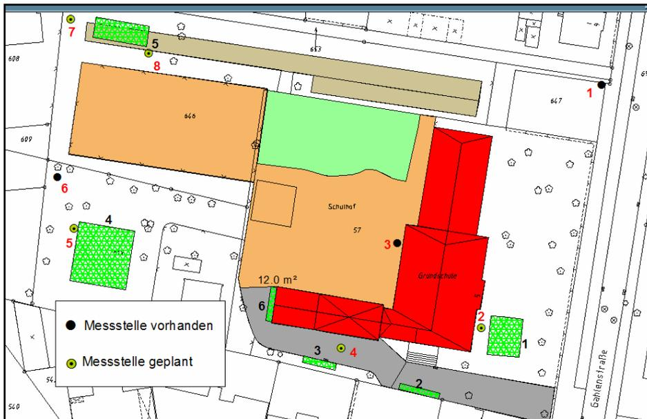
**Abb. 11: Lage der vorhandenen und der geplanten Grundwassermessstellen (grüne Flächen: geplante Muldenflächen des DVS)**
