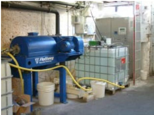
**Foto 4:** Dekanteranlage mit Polymer-Ansatzstation (FHM-Behälter)
