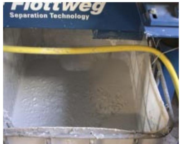
**Foto 13 + 14:** Probe des Dekanterfeststoffs und Feststoffauffangbehälter
