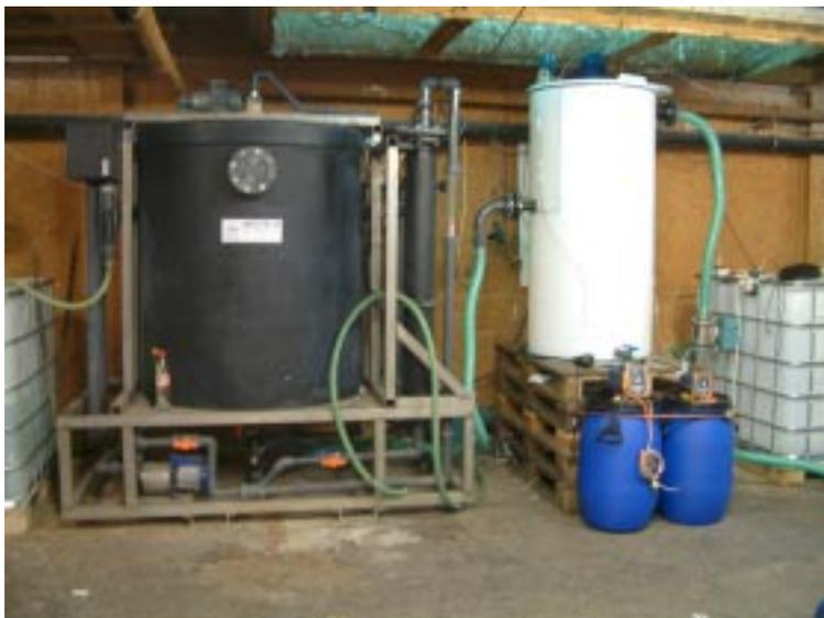
**Foto 6:** Rührbehälter RB<sub>3</sub> mit NaOH- und PAC-Dosierstationen, Flotationsanlage
