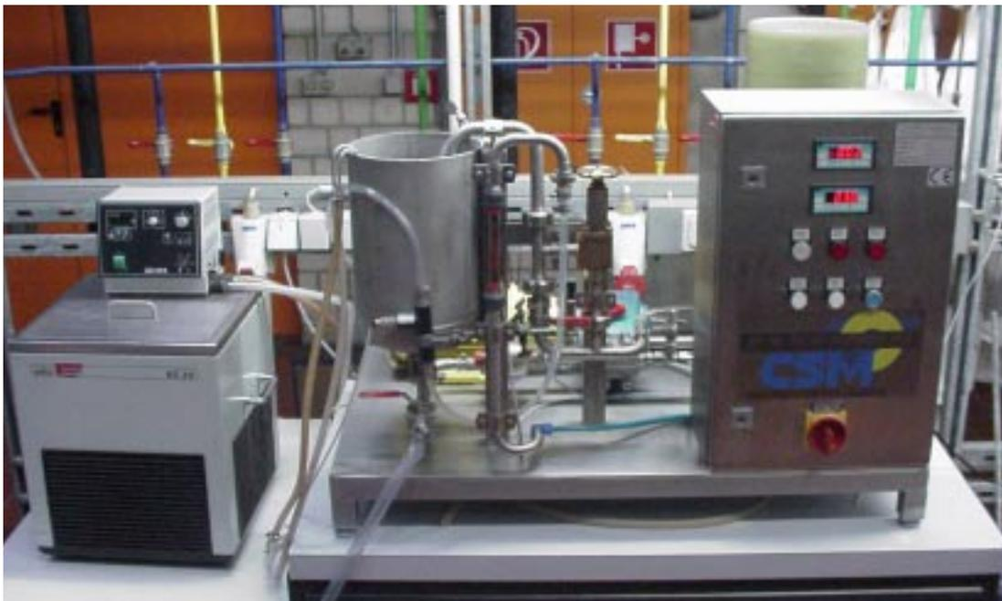
Abb. 10: Nanofiltrations- und Umkehrosmoseanlage
