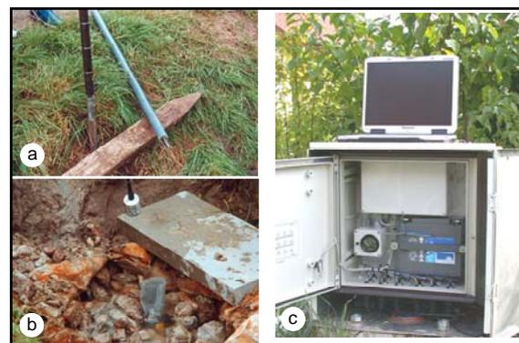
**Bild 4.2:** Feldmesstation mit Datenlogger, Feuchtemesssonde und Wasserdrucksensor
