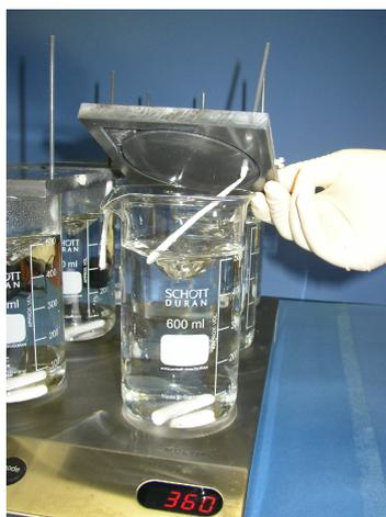
**Abb. 20** Mehrfachextraktionseinheit mit SLM-Beutelmodulen
