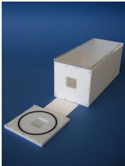
**Abb. 15** SLM-Zelle Typ III (PTFE, Feed : Strip-Volumen = 500 : 1,5)
