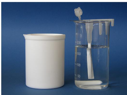
**Abb. 18** Prototyp der SLM-Beutel (Becher aus PTFE und Glas zur Aufnahme der wässrigen Feed- bzw. Probelösung)
