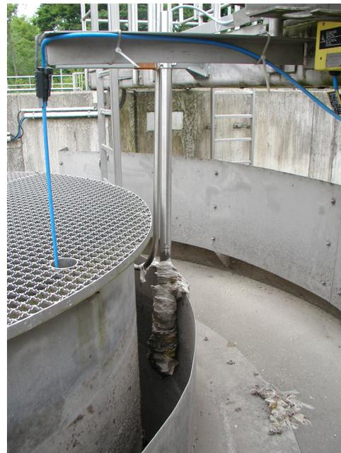
Bild 4-5: Verschmutzung der Drucksonde nach einem Ereignis
