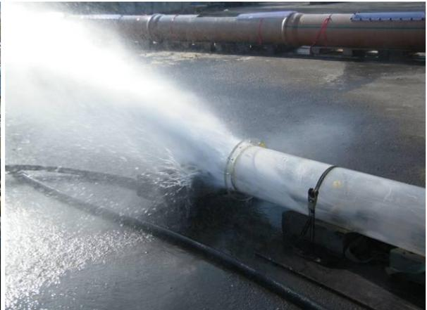
**Bild 6.9: Überprüfung der HD-Pumpe im Freistrahlabetrieb**
