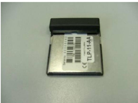
**Bild 4.21: Lesegerät mit interner Antenne**
