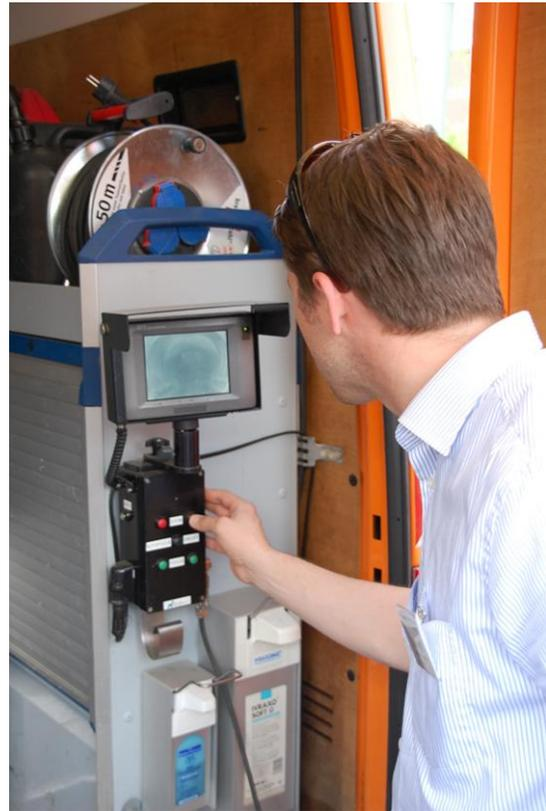
**Bild 6.2: Workshop-Eindrücke „Inspektion und Kontrolle“: Kanalspiegel im Einsatz (oben, links); Schachtkamera im Einsatz (oben, rechts); Handling der Schachtkamera (unten, links); Kamerabedienung zur Beurteilung der Ablagerungssituation (unten, rechts).**
