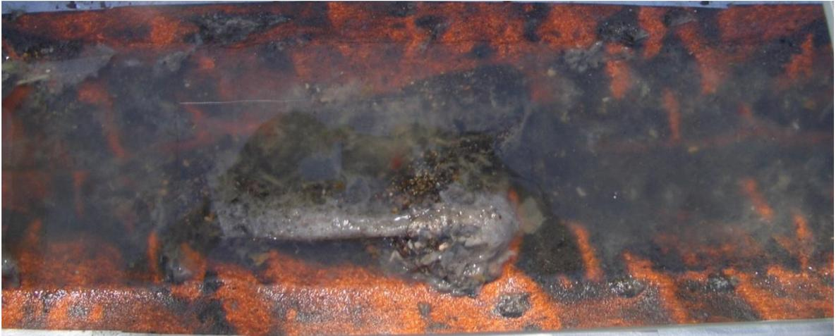
**Bild 5.17:** Ablagerungen auf Sandpapier nach zwei Tagen ( $Q=2$  L/s,  $I_S=1$  ‰,  $k_S=0,4$  mm,  $\tau=0,3$  N/m<sup>2</sup>)
