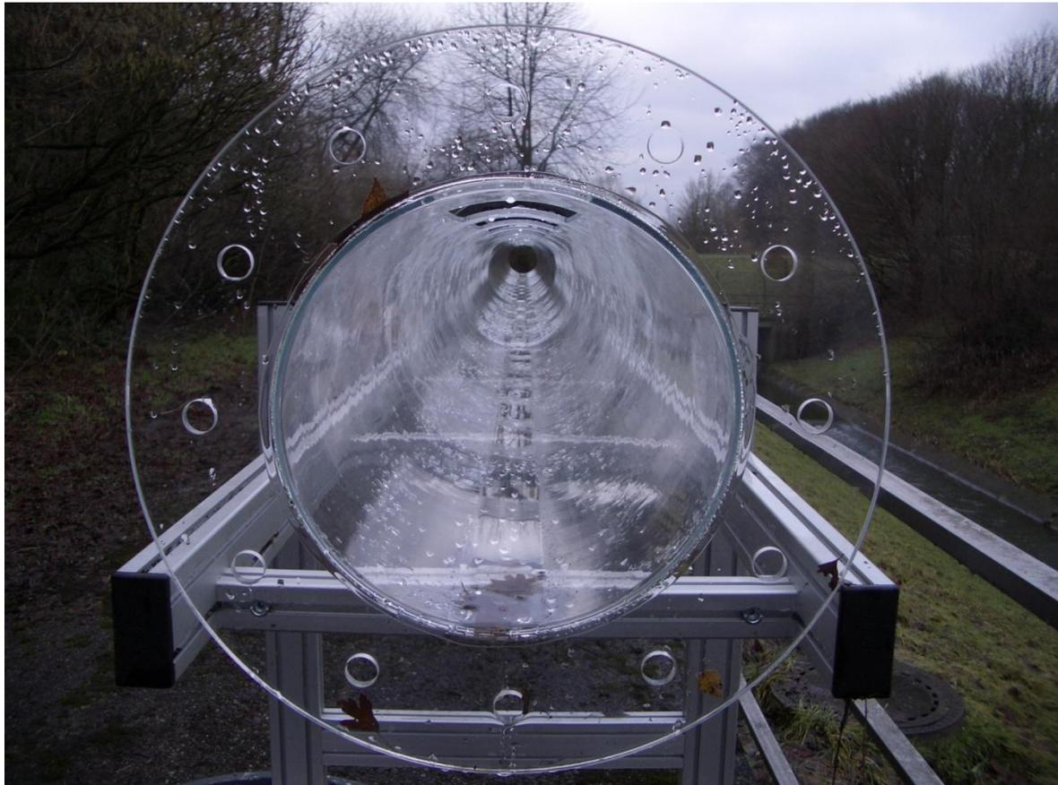
**Bild 5.2: Plexiglasrohr während der Montage**
