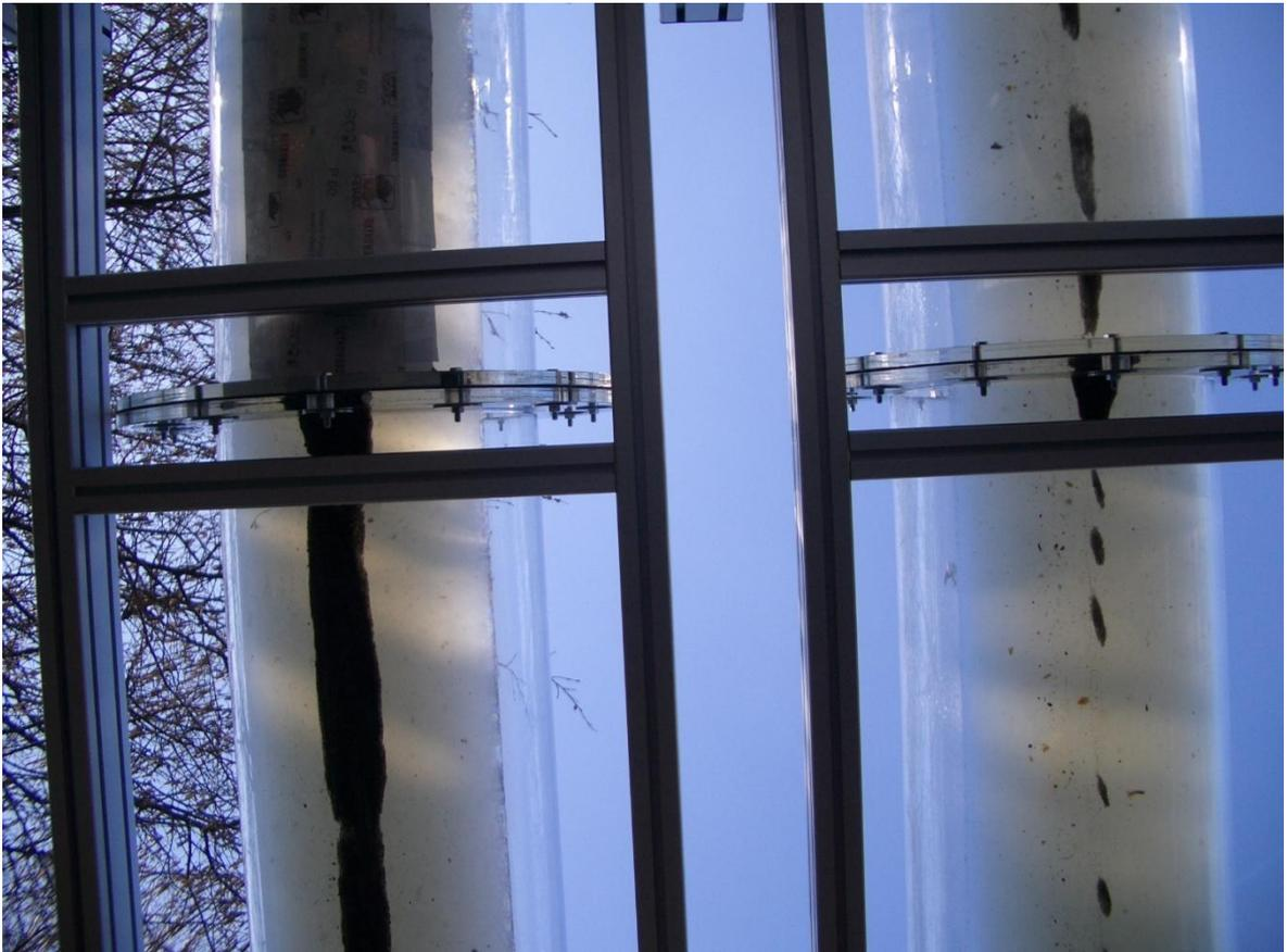
**Bild 5.18:** Ablagerungsbildung mit (links) und ohne (rechts) Sandpapier bei ansonsten gleichen Randbedingungen ( $Q=2$  L/s,  $I_S=1$  ‰), Fließrichtung von unten nach oben
