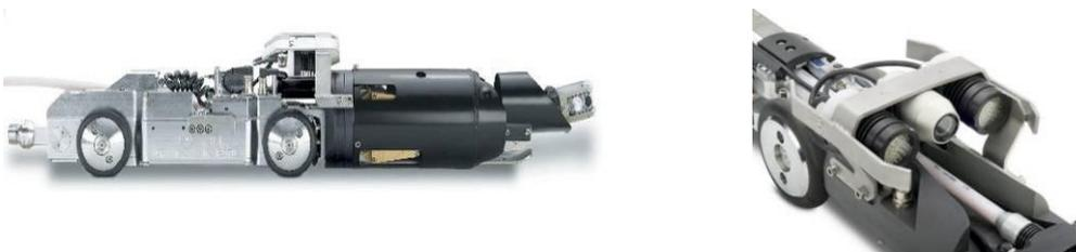
**Bild 4.8:** TV-Inspektionskamerawagen (IBAK GmbH, 2011)
