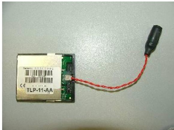
**Bild 4.20: Lesegerät mit externer Antenne**
