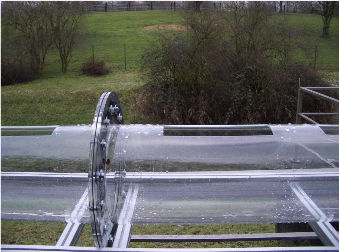
**Bild 5.4: Plexiglasrohr mit Ausschnitten im Scheitel**
