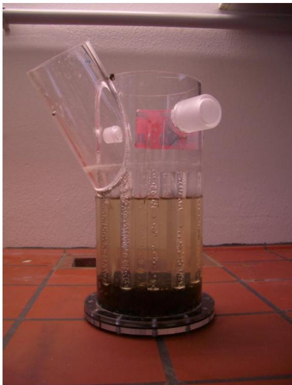
**Bild 5.34: Plexiglasbehälter zur Messung des Erosionswiderstandes von Sedimenten**
