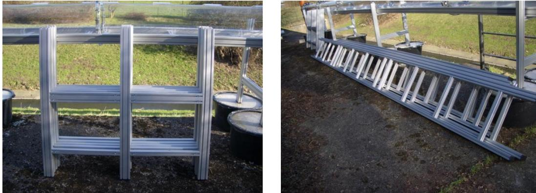
**Bild 5.5:** Unterkonstruktion für die Versuchsrohre (links: Vertikale Stützen mit höhenverstellbaren Querstreben; rechts: Horizontale Träger als Auflage für die Versuchsrohre)
