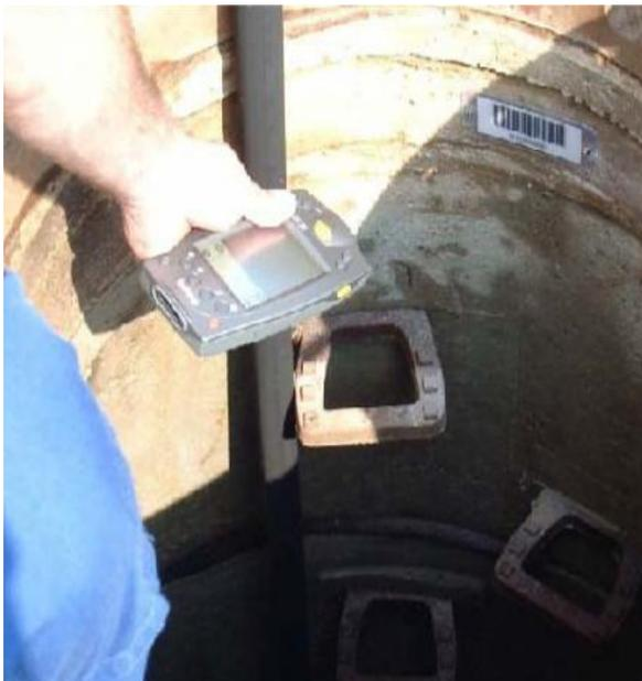
**Bild 4.23: Barcodelesegerät**
