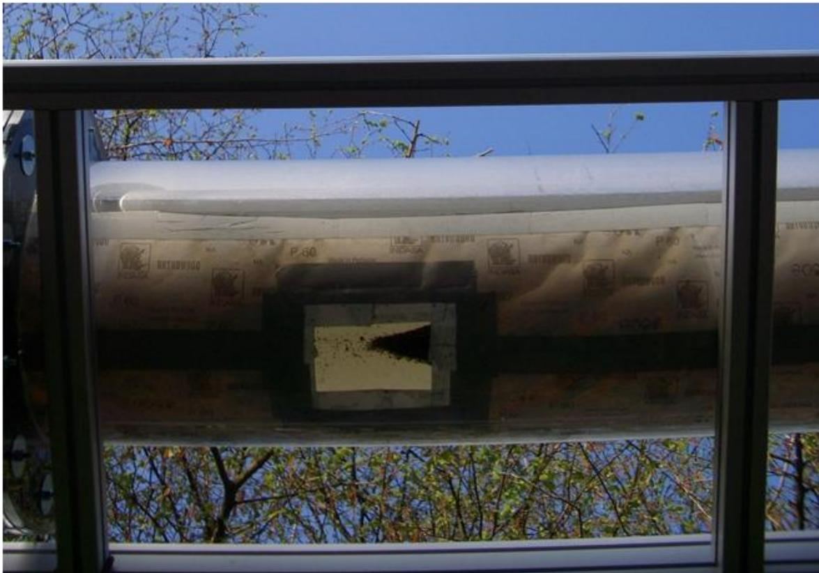
**Bild 5.29: Versuchsrohr mit „Sichtfenster“ im Schleifpapier**
