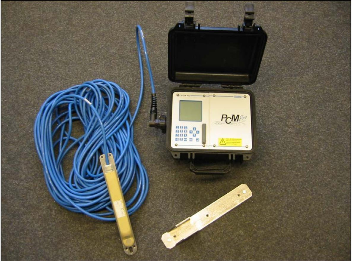
**Bild A 3:** Eingesetztes Durchflussmessgerät PCM-Pro der Nivus GmbH
