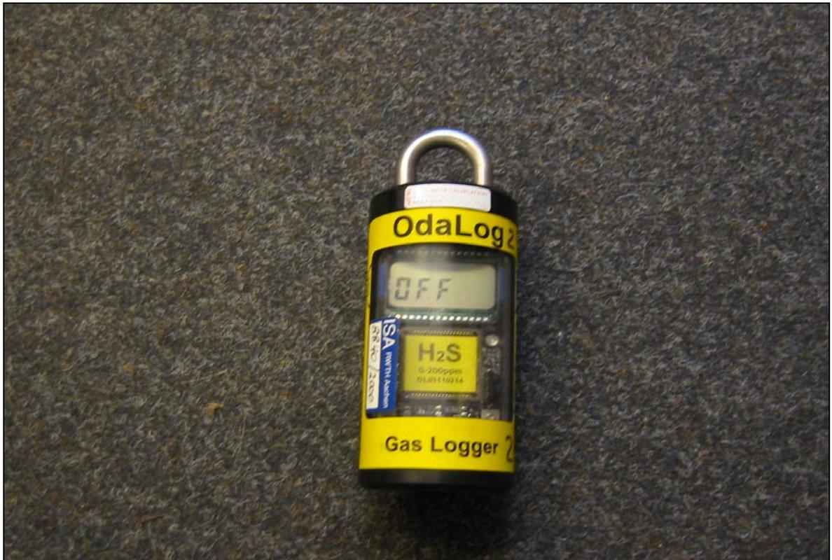
**Bild A 5:** Eingesetztes Messgerät (OdaLog) zur kontinuierlichen Erfassung von Schwefelwasserstoff in Kanalatmosphäre
