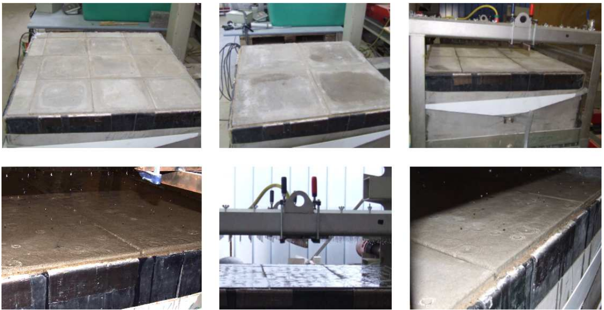
Abbildung 45: Flächenbeläge aus fugenarm verlegten Gehwegplatten
