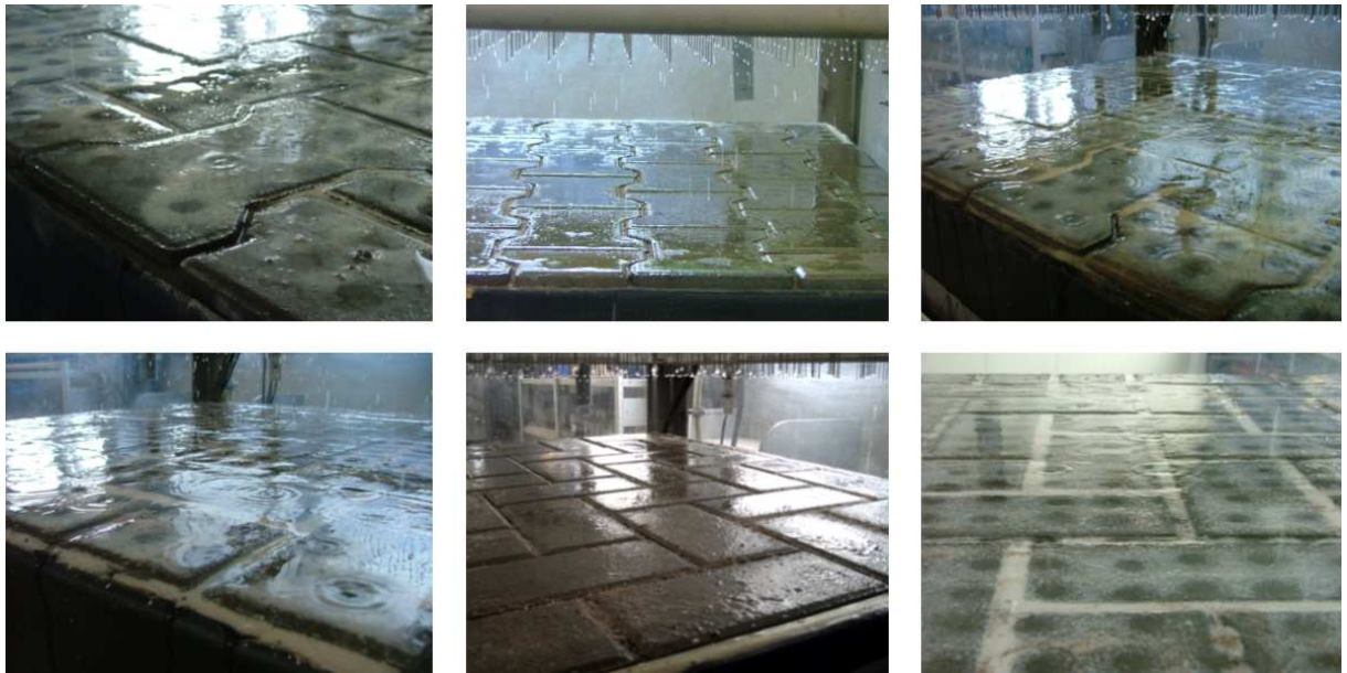
Abbildung 28: Flächenbeläge aus fugenarmem Doppelverbund- und Rechteckpflaster
