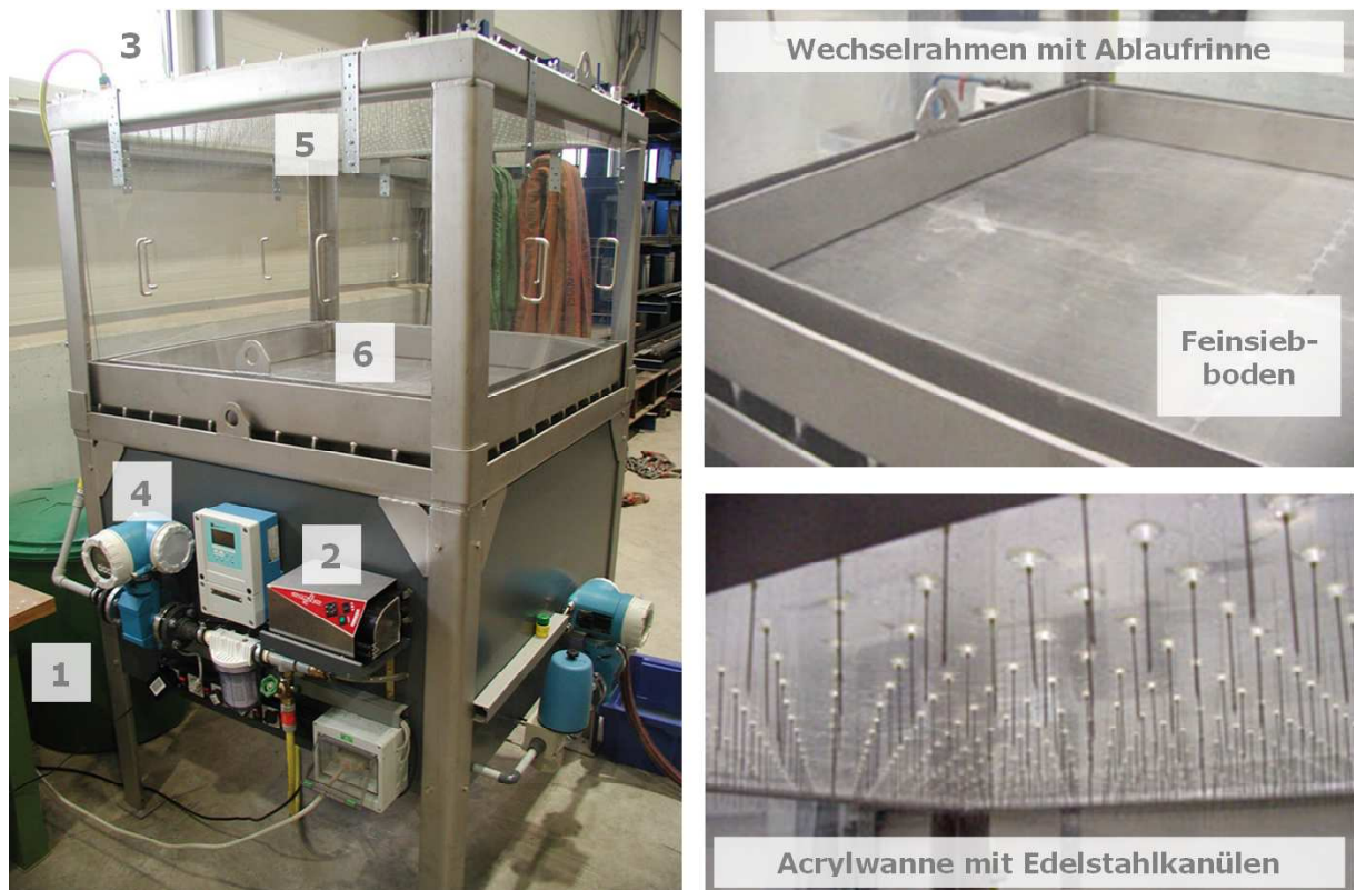
Abbildung A - 8: Prüfanlage für wasserdurchlässige Flächenbeläge im IKT mit: (1) Vorlagebehälter, (2) Schlauchpumpe, (3) Zulauf zur Beregnungseinheit, (4) MID, (5) Acrylwanne mit Kanülen 6) Wechselrahmen
