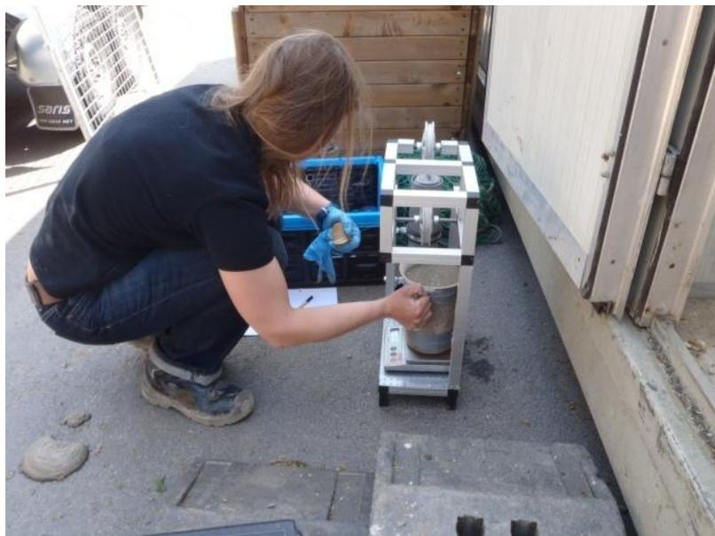
BILD 149: GEWICHTSMESSUNG DER SUSPENSION MIT EINGETAUCHTEM FLÜGELPENDEL
