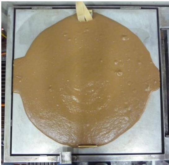
BILD 51: AUSBREITMAß UNMITTELBAR NACH ABZIEHEN DES KONUS (30 MINUTEN NACH DEM ANMISCHEN)
