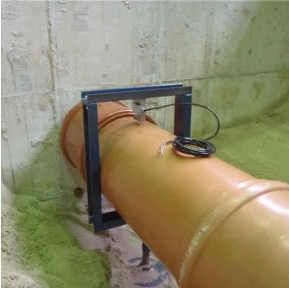
BILD 107: KRAFTMESSDOSE AM AUFLAGER
