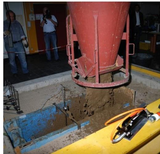
BILD 110: VERFÜLLEN DES ROHRGRABENS MITTELS BETONBOMBE
