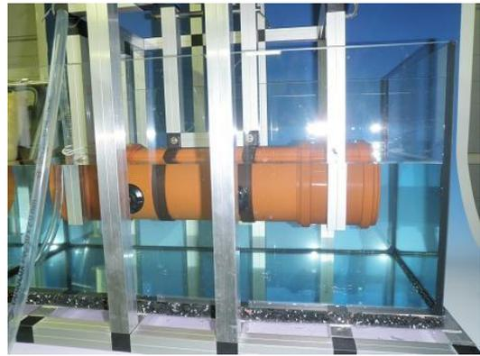
BILD 20: LABORVERSUCH ZUR AUFTRIEBSWIRKUNG VON WASSER
