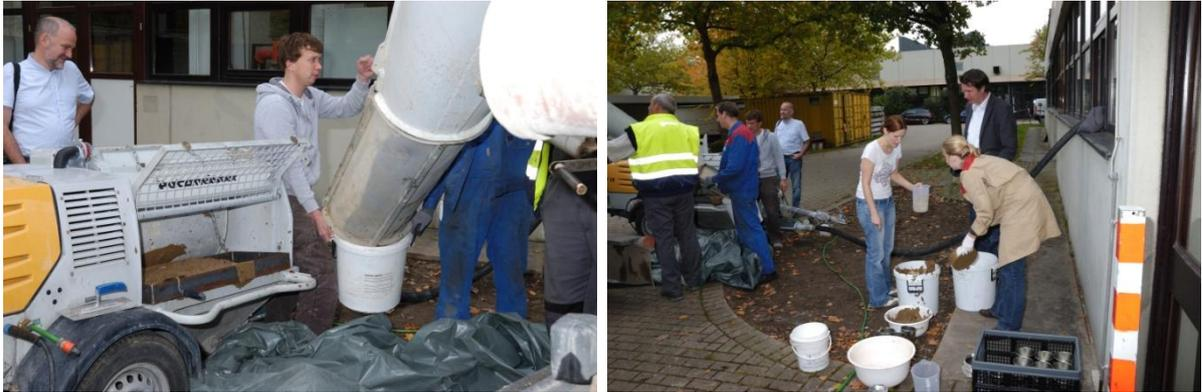
BILD 112: ERHEBUNG RÜCKSTELLPROBEN FÜR MESSUNG DER FLIEßGRENZE IM LABOR
