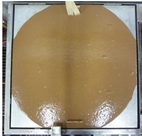
BILD 52: AUSBREITMAß NACH 15 SCHLÄGEN (30 MINUTEN NACH DEM ANMISCHEN)
