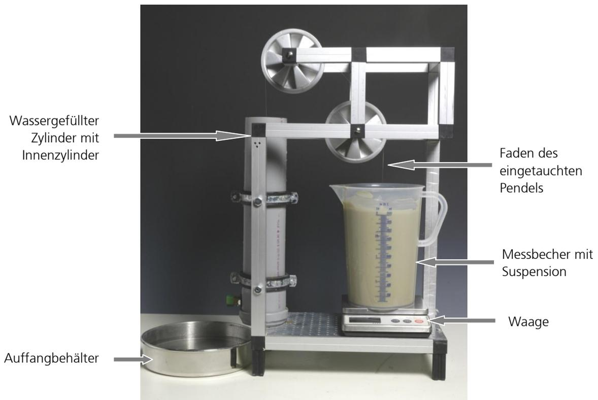
BILD 147: VERTIKALPENDELGERÄT
