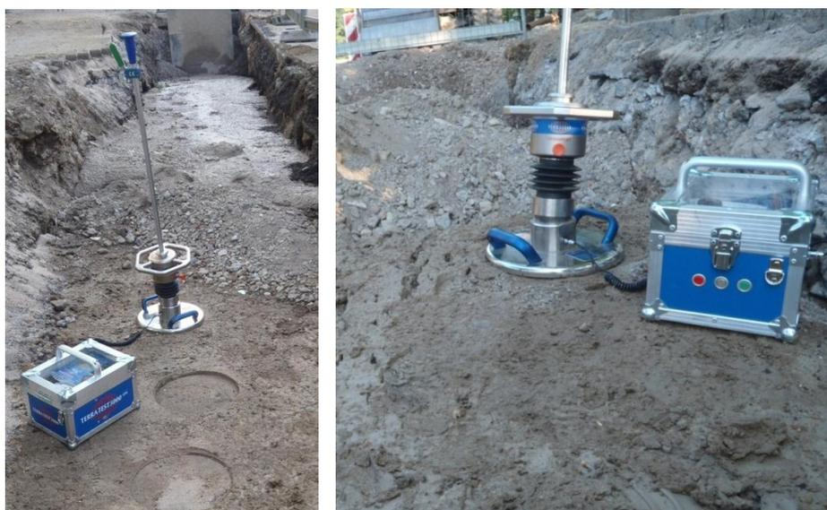
BILD 145: LEICHTES FALLGEWICHTSGERÄT
