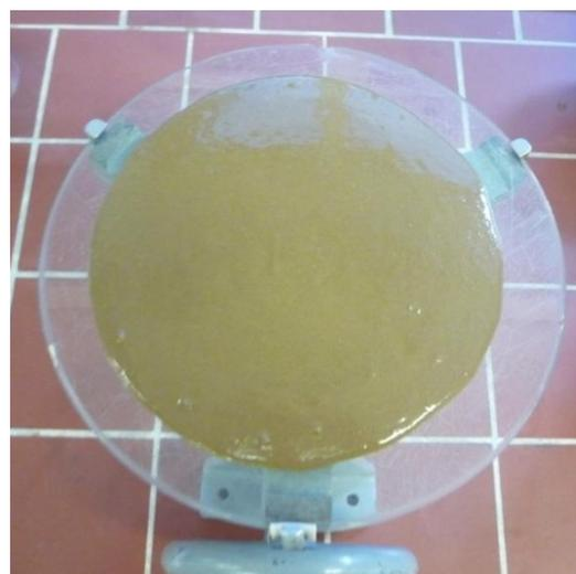
BILD 42: FLÜSSIGBODENPROBE NACH AUFBRINGEN DER 15 HUBSTÖBE
