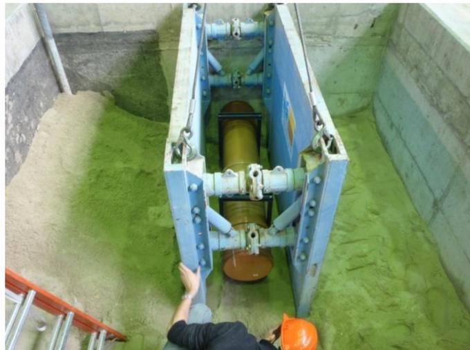
BILD 106: VERBAUBOX IN DER VERSUCHSGRUBE
