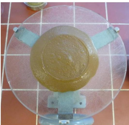
BILD 41: FLÜSSIGBODENPROBE NACH ABZIEHEN DES SETZTRICHTERS
