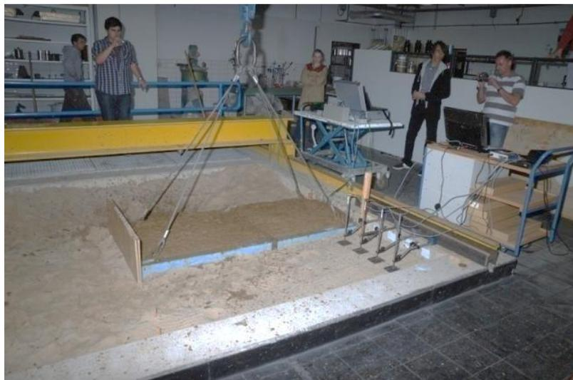
BILD 113: ANSCHLAGEN DER VERBAUBOX AM PORTALKRAN
