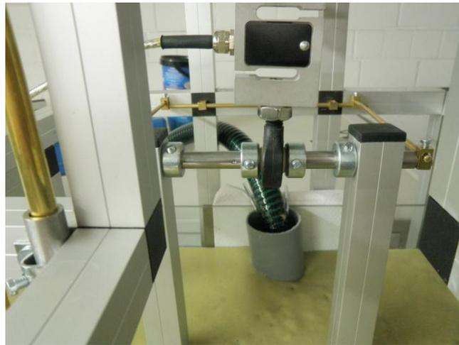
BILD 89: EINFÜLLEN DER BENTONITSUSPENSION
