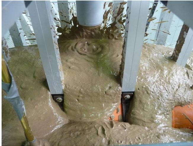
BILD 22: NIEDRIGER SUSPENSIONSSPIEGEL OBERHALB DES ROHRES
