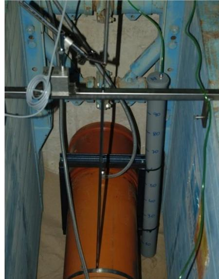
BILD 108: DRUCKDOSE (RECHTS HINTEN) UND LAGEMESSER (MITTIG AUF ROHR)
