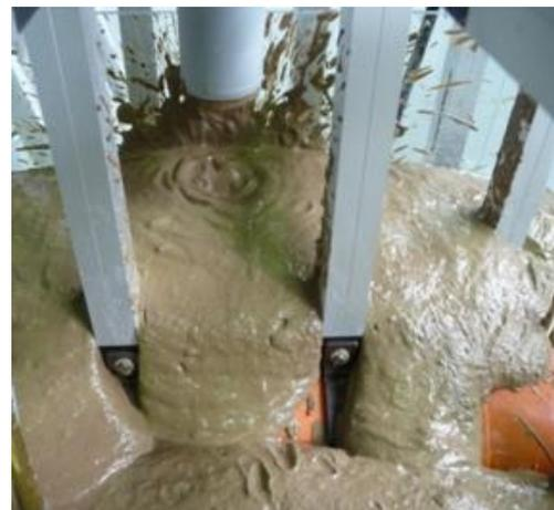
BILD 94: ROHRUMSTRÖMUNG BEI FLÜSSIGBODEN
