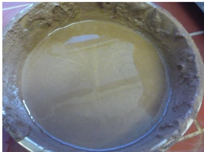
BILD 45: WASSERFILM AUF EINER FLÜSSIGBODENPROBE
