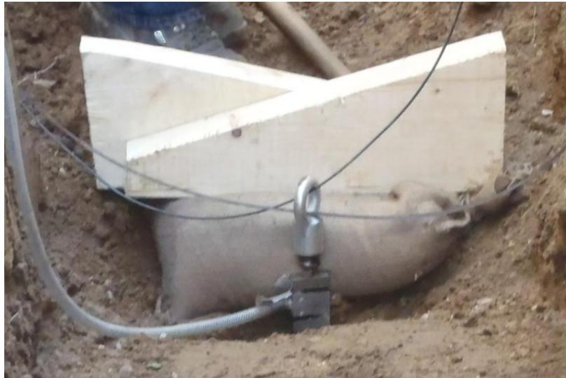
BILD 128: KRAFTMESSDOSE AM KOPF EINES ANKERPFAHLS
