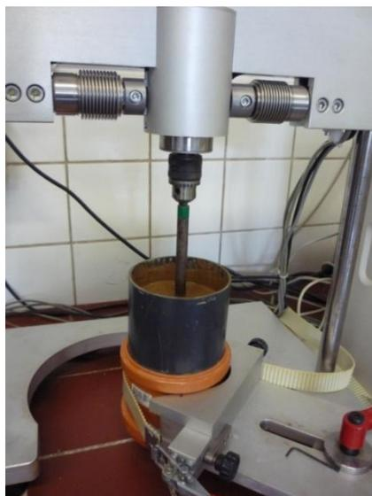
BILD 68: FLÜGELSCHERGERÄT FÜR LABORUNTERSUCHUNGEN
