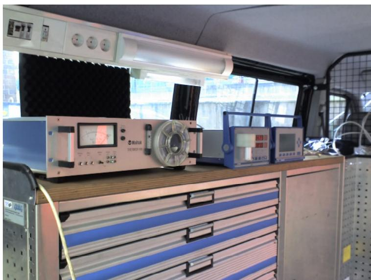
*Kontinuierliche Messung von  $\text{H}_2$ ,  $\text{CO}$ ,  $\text{CO}_2$  und  $\text{CH}_4$*
