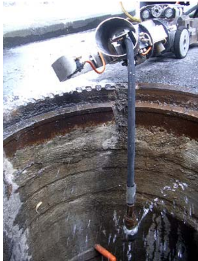
Bild 24: ORION L, Kieler Stäbchen, Beispiel mit Spüldüse zur Vorreinigung
